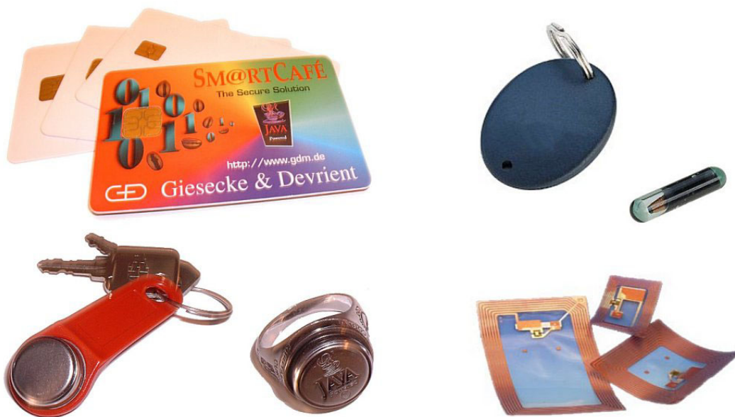
Abbildung 2.2: Smart Cards, iButtons und diverse Transponder
