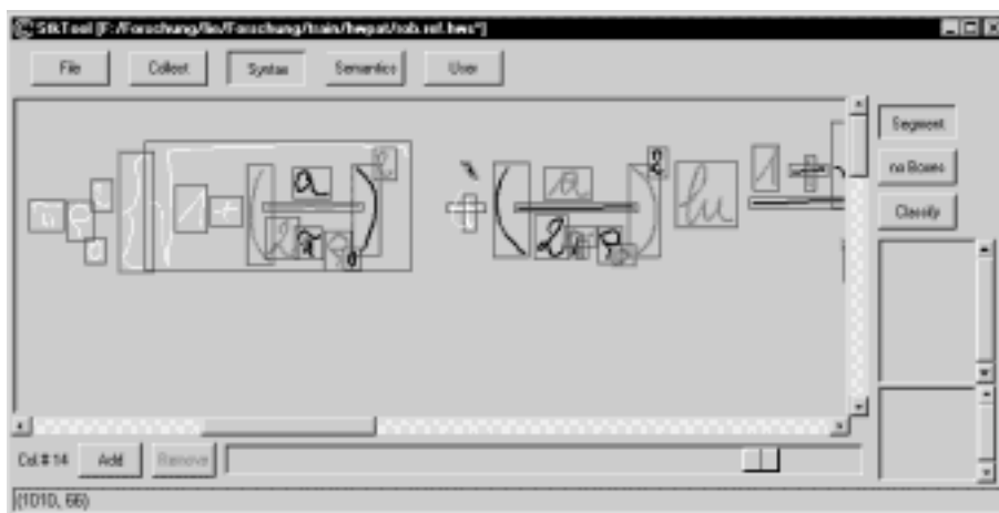
Abb. 5.5: STKTOOL, Arbeitsbereich Segmentierung. Im Ausgangszustand erscheinen alle erfassten handschriftlichen Linienzüge in alternierender Farbdarstellung gemäß Schreibreihenfolge (hier: abwechselnd schwarz und dunkelgrau). Während der Stiftgesten-Ausführung werden die angewählten Linienzüge farblich hervorgehoben (hier: weiß), danach weisen sie eine gemeinsame bounding box auf. Die Stiftgesten-Trajektorie wird während der Ausführung als dünne Spur angezeigt (hier: weiß). Die alternierende Farbgebung wird analog auf die entstandenen Segmentierungsgruppen übertragen. Linienzuggruppen, die bereits semantisch und/oder syntaktisch annotiert wurden (s.u.), werden in einer weiteren, einheitlichen Farbe dargestellt (hier: hellgrau).
