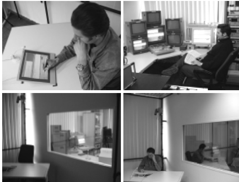
Abb. 6.3: Versuchsdurchführung im Usability-Labor. Oben: Versuchsperson (links) und Versuchsleiter (rechts) im WIZARD-OF-OZ-Szenario. Unten: Blick aus dem abgedunkelten Probandenraum in den Regieraum (halbdurchlässiger Spiegel, links), Ansicht während des Versuchsablaufs (rechts).
