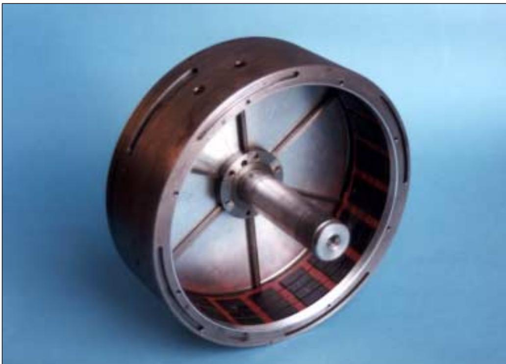
Bild 5.7: Seitenansicht des Rotors – gesehen vom Flansch
