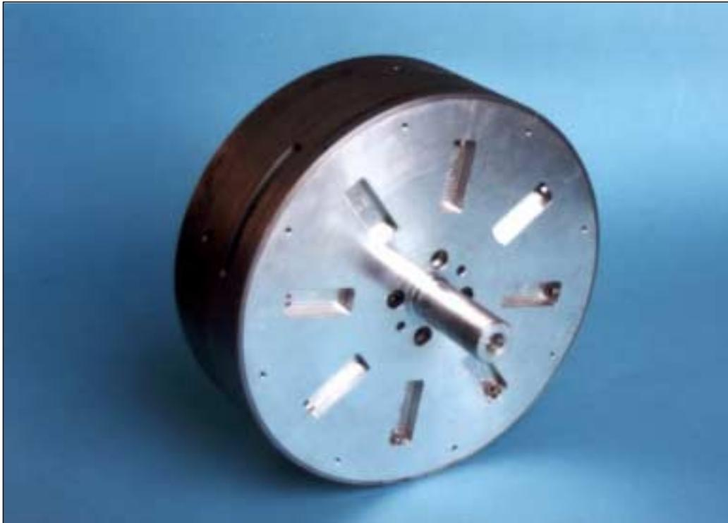
Bild 5.6: Seitenansicht des Rotors – gesehen von der Abtriebsseite
