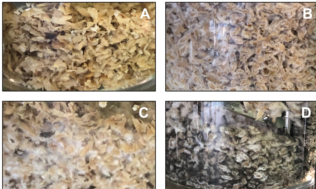
Abbildung 5.4: Umsetzung von Zuckerrübenpressschnitzel mit A. niger ATCC 11414 \Delta\text{gaaX} im feuchten Haufwerk: Abbildung des feuchten Haufwerks nach (A) 1 h, (B) 44 h, (C) 94 h und (D) 115 h. Nach 115 h wurde eine starke Sporenbildung festgestellt. ( T = 30^\circ\text{C} , F_{\text{Luft}} = 1 \text{ L h}^{-1} , \text{pH}_0 = 4,5 , C_{\text{ZRPS}} = 281 \text{ g L}^{-1} , 6,25 \times 10^6 Sporen \text{g}_{\text{ZRPS}}^{-1} ).
