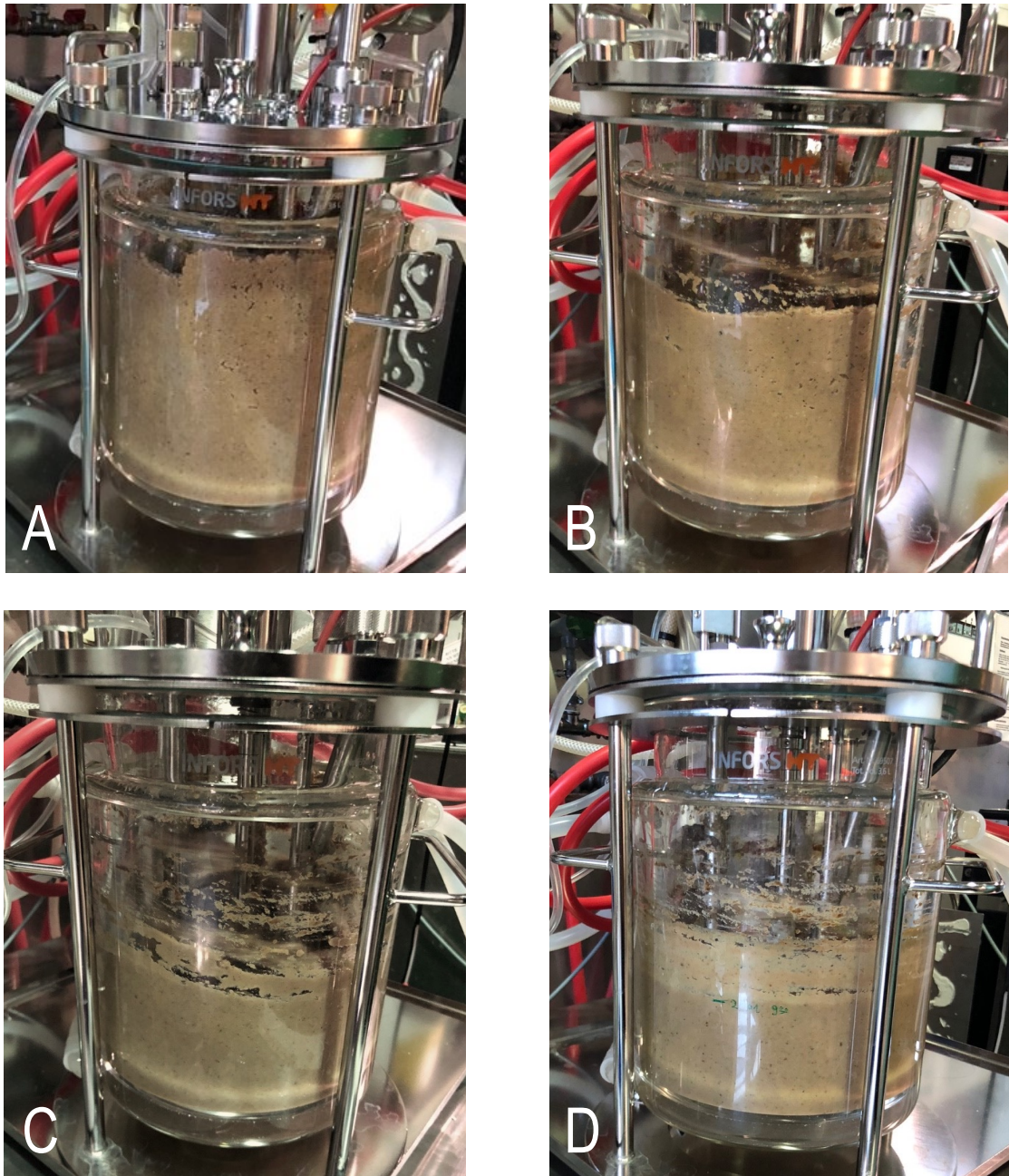
Abbildung 10.1: Umsetzung von gemahlenen Zuckerrübenpressschnitzel mit A. niger ATCC 11414 \Delta gaaX im Rührkesselreaktor: Bildaufnahme nach (A) 46 h, (B) 63 h, (C) 72 h und (D) 88 h. Zur Verbesserung der Sauerstoffversorgung wurde die Begasungsrate schrittweise (blau gestrichelte Linien: nach 16 h auf 1 \text{ L h}^{-1} , nach 42 h auf 3 \text{ L h}^{-1} ) und die Rührerdrehzahl nach 42 h auf 40 \text{ min}^{-1} erhöht. Die Verflüssigung des feuchten Haufwerks zur Suspension trat nach 42 h auf. ( T = 30 \text{ }^{\circ}\text{C} , n_{\text{initial}} = 10 \text{ min}^{-1} , F_{\text{Luft, initial}} = 0,2 \text{ L h}^{-1} , \text{pH}_0 = 4,5 , c_{\text{ZRPS}} = 227 \text{ g L}^{-1} , 2,57 \times 10^6 Sporen \text{g}_{\text{ZRPS}}^{-1} ).
