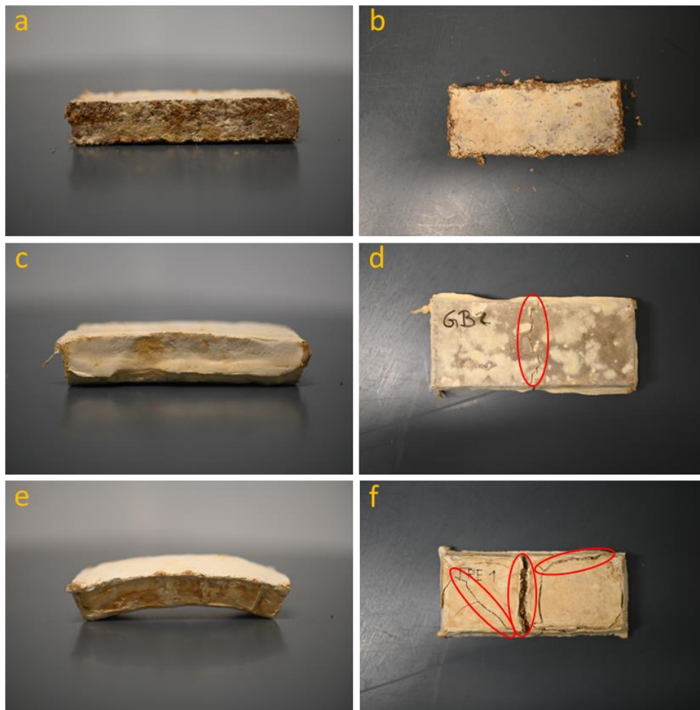
Abbildung 12: Der Grad der Krümmung vor der Durchführung des Kompressionsversuches wird für die Komposite von F. fomentarius und Roteiche (a), G. sessile und Buche (c) sowie T. versicolor und Roteiche (e) dargestellt. Nach Durchführung des Kompressionsversuches gibt es für F. fomentarius und Roteiche keinen sichtbaren Bruch (b), für G. sessile und Buche einen sichtbaren Bruch (d) sowie für T. versicolor und Roteiche multiple sichtbare Brüche (f).
