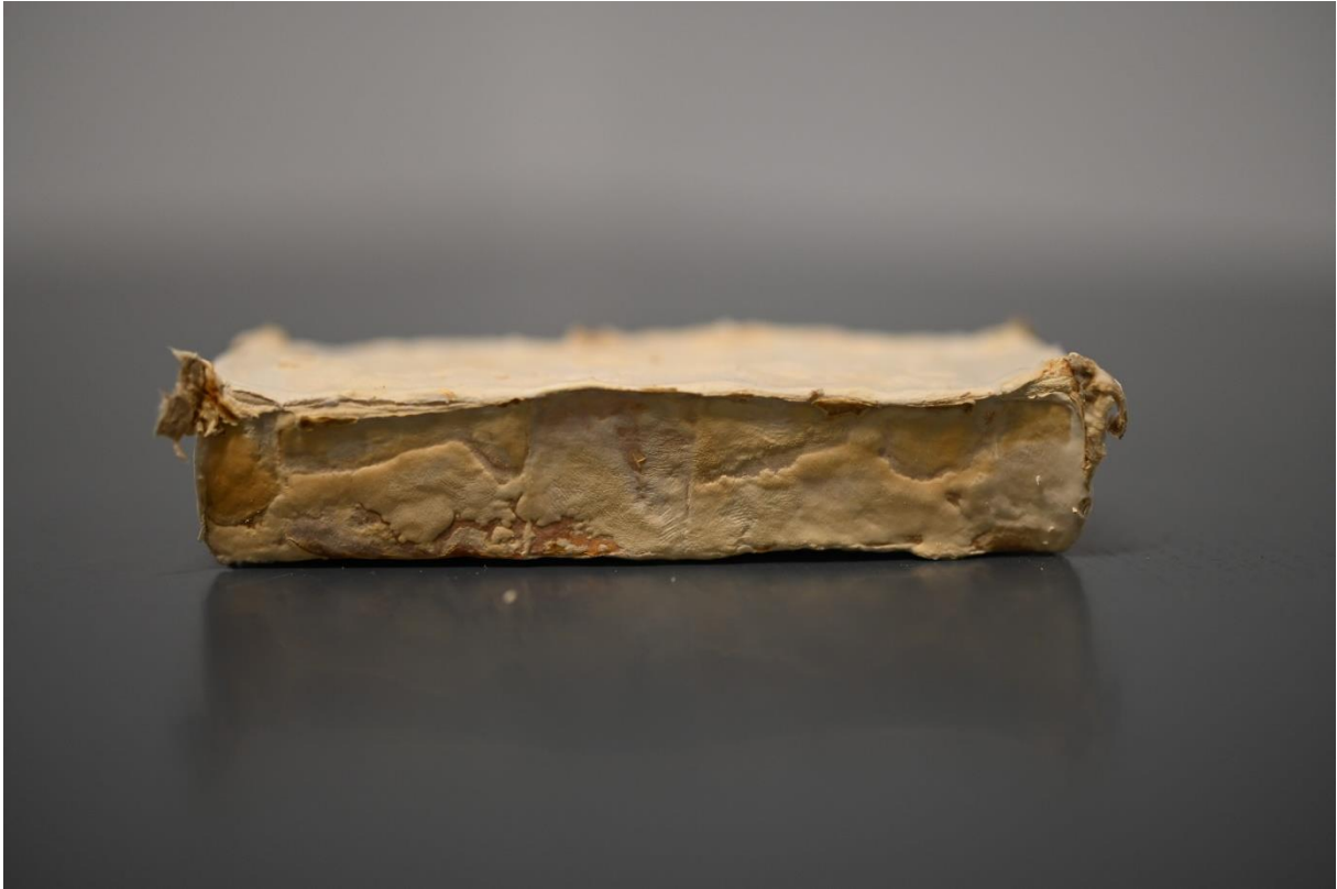
Abbildung 24: Es wird ein Komposit von T. versicolor und Buche vor Durchführung des Kompressionsversuches mit keiner sichtbaren Krümmung dargestellt.
