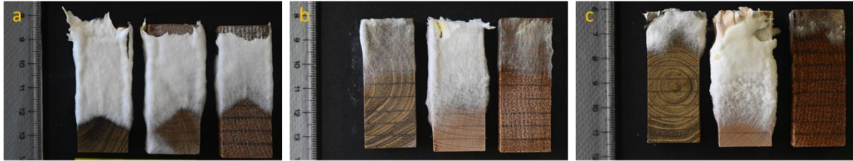
Abbildung 3: Es wird das ausgebildete Pilzmyzel auf den Wafern mit G. sessile (a), T. versicolor (b) und F. fomentarius (c) nach Beendigung der Wachstumsversuche dargestellt. Die Markierungen auf den Holzwafern weisen einen Abstand von 5 mm zueinander auf. Von links nach rechts sind jeweils die Holzarten in der Reihenfolge Robinie, Buche und Roteiche aufgereiht.
