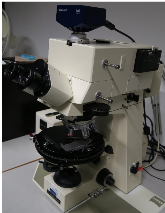
Abbildung 21: Auflichtmikroskop Axiophot der Firma Zeiss mit integrierter Kamera (AxioCam)
