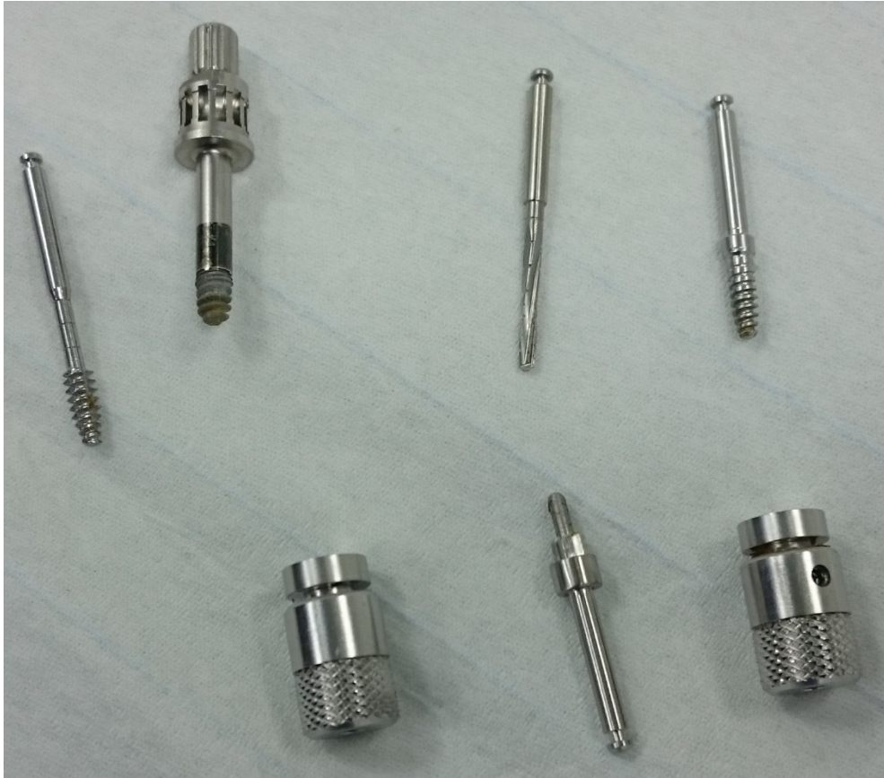
Abbildung 2: Autoklavierbares Mehrweg-Instrumentarium (v.l.n.r.): Gewindeschneider, Schraubenaufnehmer mit Schraube, Bohrer, Gewindeformer, Aufnehmer, Tiefenmessgerät, Aufnehmer
