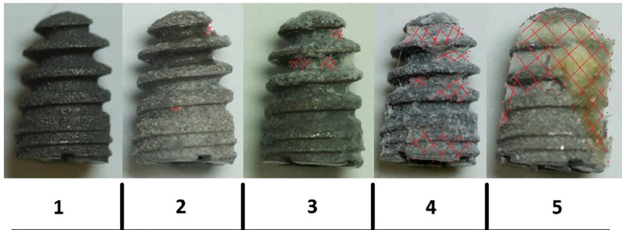
Abbildung 5: Scoring der anhaftenden Knochenstücke anhand der prozentualen Oberflächenabdeckung (rot schraffiert)
