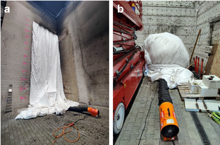
Abbildung 5.8 Varianten der Pflanzentrocknung mit Bautrockner und Plane a) direkt an der Fassade und b) vor der Montage an die Fassade
