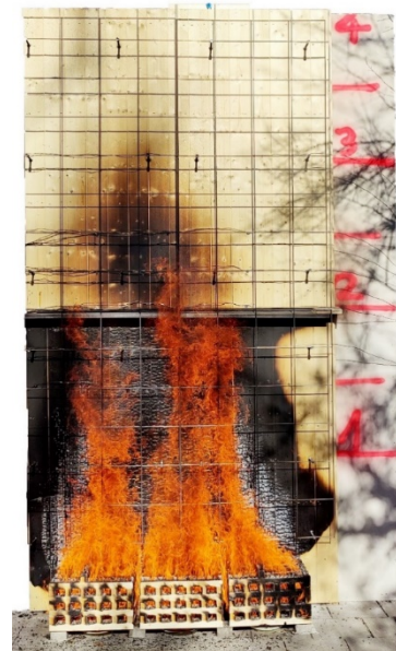
Abbildung 4.5 Brandeinwirkung durch drei 15 kg Holzkippen für den Referenzversuch Test 1 (8. Prüfminute)
