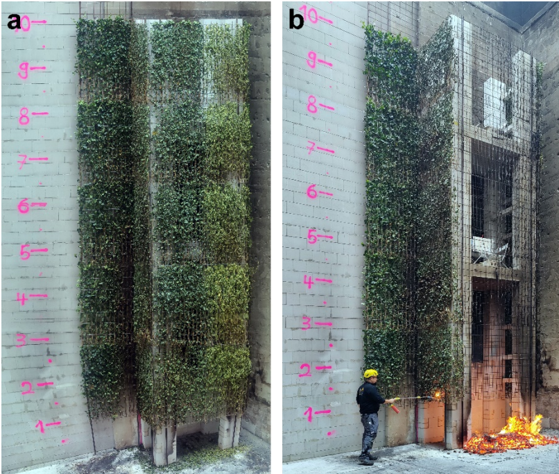
Abbildung 5.52 Versuch V7 a) vor der Prüfung und b) nach der Prüfung
