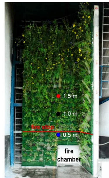
Abbildung 2.6 Temperatur-Zeit-Diagramm (links) im Hinterlüftungsspalt in verschiedenen Höhen (0,5 m über dem Brandraum (unter der Brandsperre), 1,0 m und 1,5 m über dem Brandraum (über der Brandsperre)); Foto des Prüfstands mit Anordnung der Messstellen im Hinterlüftungsspalt; basierend auf [127]
