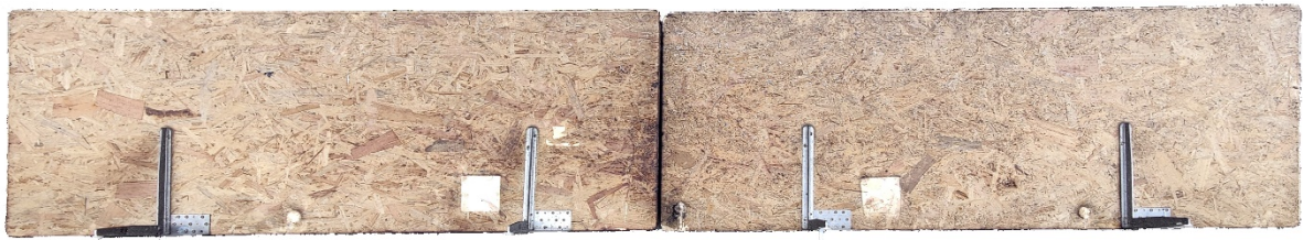
Abbildung 5.60 Foto der dem Feuer ausgesetzten Seite der 15 mm dicken OSB-Platten nach dem Test V2
