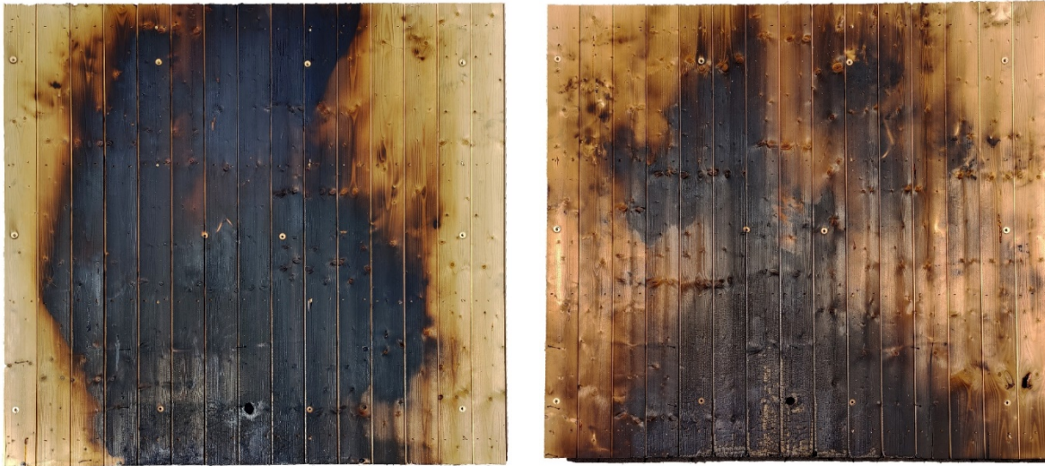
Abbildung 4.12 Fotodokumentation der Holzschalung oberhalb der Brandsperrre nach Beendigung des Versuches und der Beobachtungszeit für Test 2 (links) und Test 3 (rechts) [3]
