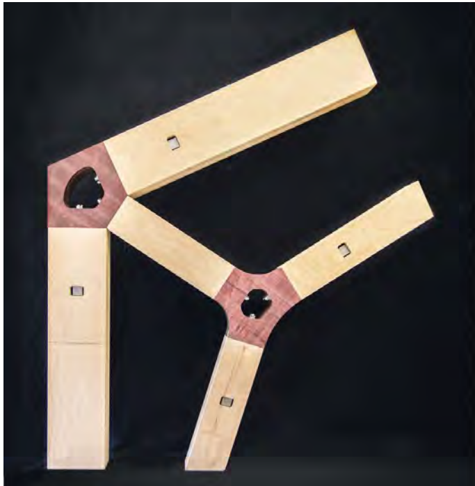
Bild 11 Mock-up (M 1:1) des reversiblen Trauf- und inneren Druckknotens Mock-up (scale 1:1) of the reversible eaves and inner pressure node
