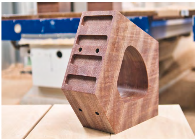
Bild 9 Traufknoten aus Kunstharzpressholz (KP) – Querkraftanschluss über Schubnocken Eaves node made of synthetic resin pressed wood (KP) – lateral force connection via thrust cam
