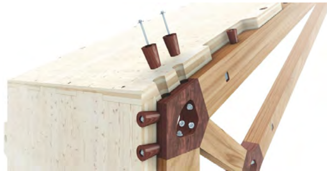
Bild 10 Detaildarstellung des reversiblen Anschlusses einer elementierten BSP-Decken- und Wandplatte an den Dreigelenkrahmen im Bereich des Traufknotens
