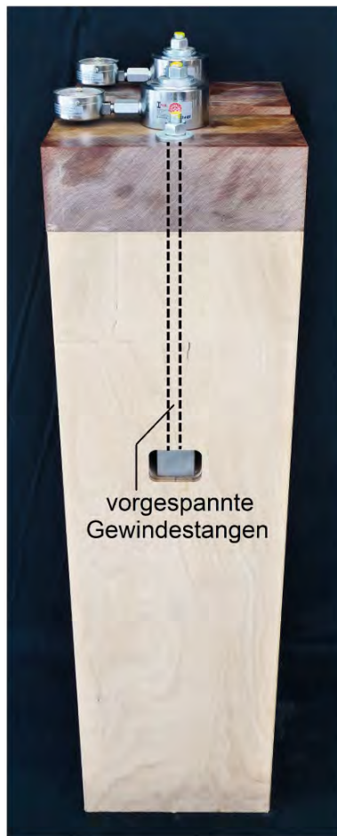
Bild 14 Langzeitversuche zum Vorspannkraftverlust der reversiblen Knotenverbindungen der Dreigelenkrahmen der Werk- und Forschungshalle unter Luftfeuchtigkeit, Temperatur, Kriechen und Relaxation Long-term tests on the loss of prestressing force of the reversible node connections of the three-hinged frames of the work and research hall under humidity, temperature, creep and relaxation
