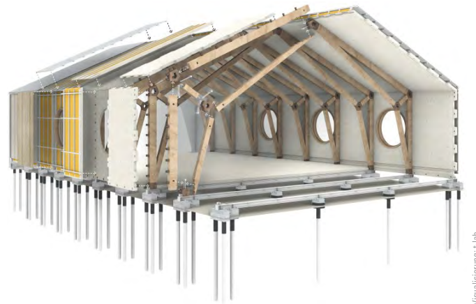
Bild 7 100 % Reversibilität aller Bauteile der Werk- und Forschungshalle 100 % reversibility of all structural elements of the work and research hall
