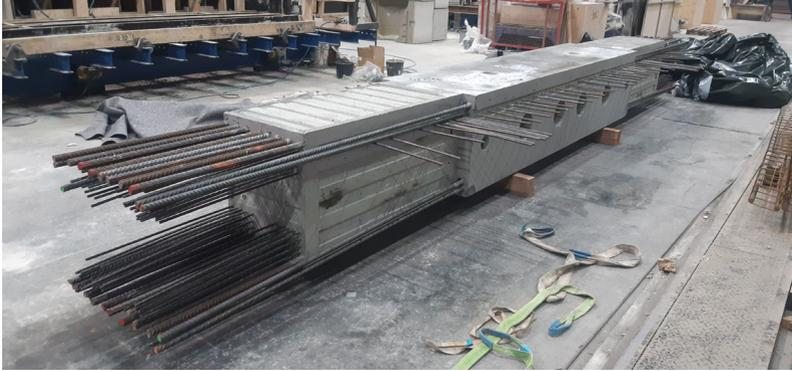
**Abb. 8:** Koppelriegel im Fertigteilwerk (Bild Fa. Rekers, Spelle)
