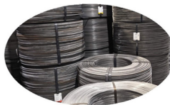
(b) Betonstahl vom Ring
