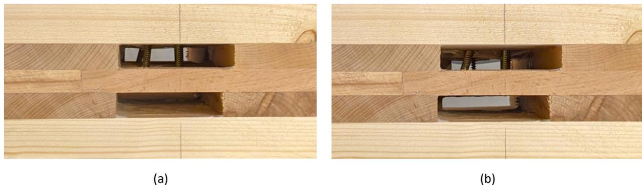
Abbildung 4-13: Prüfkörper 60-140-2 (a) vor und (b) nach dem Versuch
