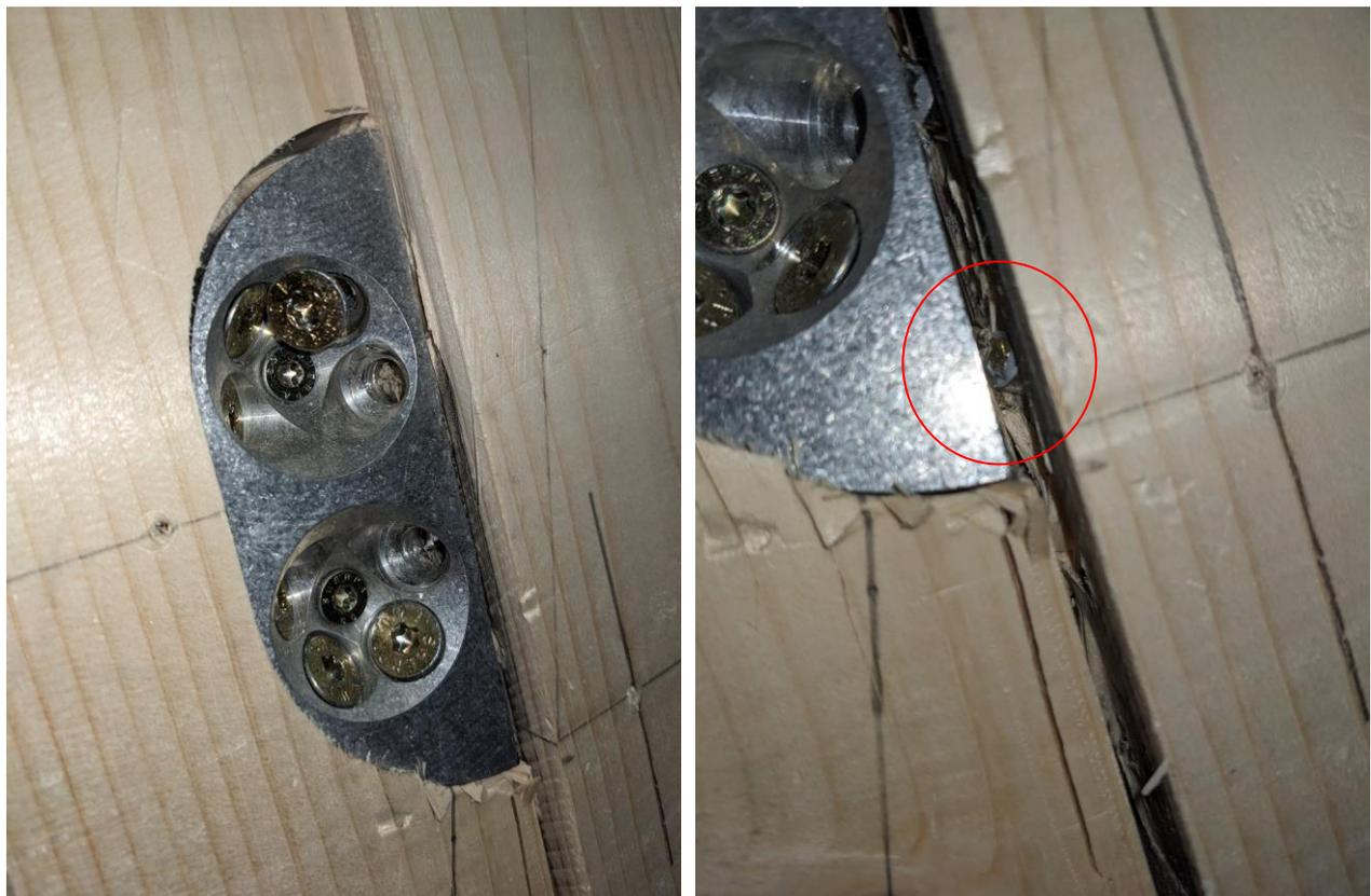
Abbildung 4-10: CLT-Connector nach Abdrücken
