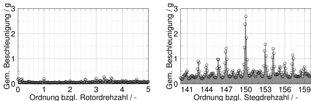
Abbildung 8.8: Referenzvariante: Gemittelte Ordnungsspektren niedriger RO (links) und rund um die 1. ZEO (rechts) im unterkritischen Drehzahlbereich
