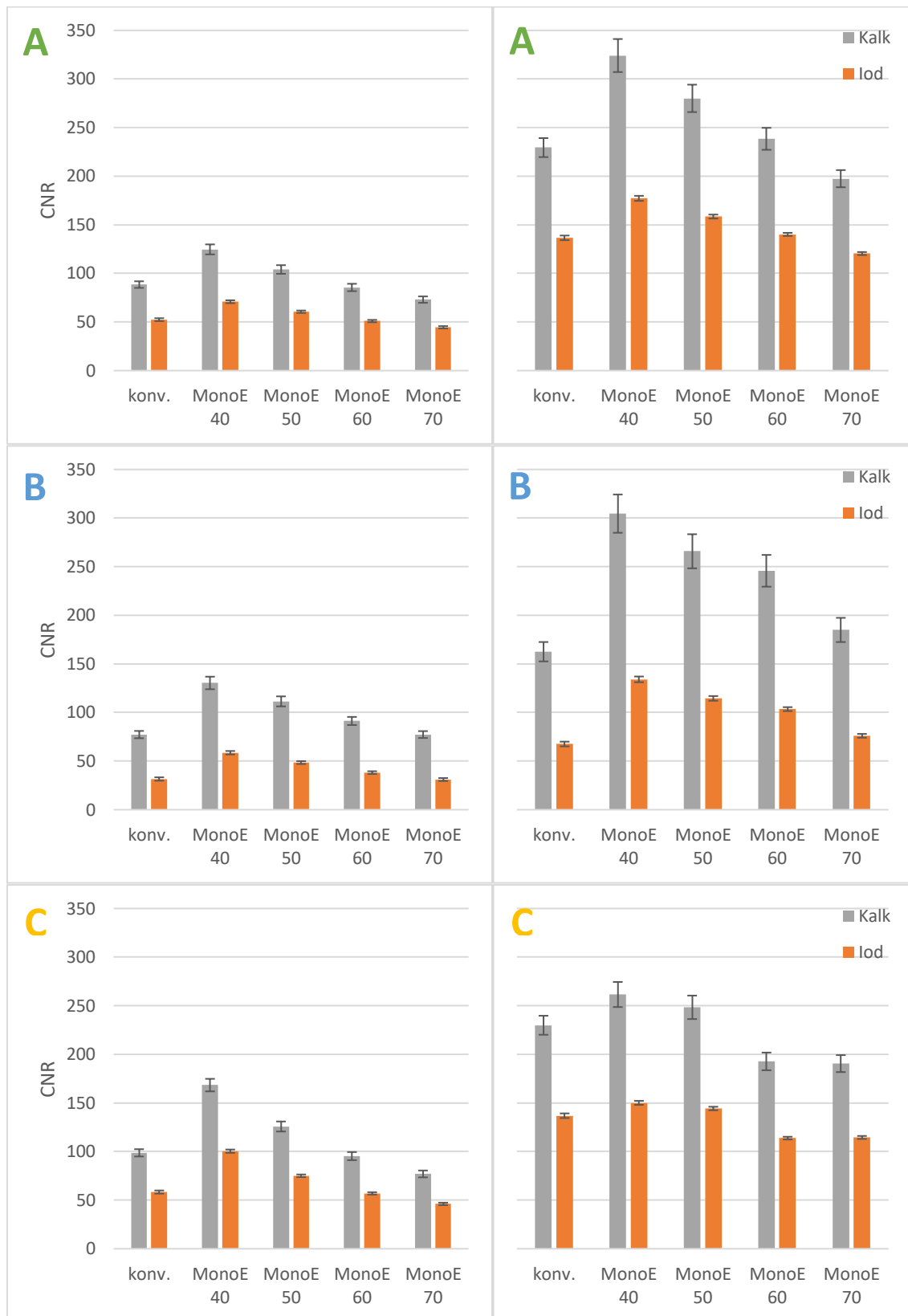
Abbildung 19: Vergleich des Th-Protokolls bei 5,3 mGy (links) und 90,3 mGy (rechts) anhand der CNR von Kalk (grau) und Iod (orange) in konv. Bildern und VMI; Hintergrund: Ethanol (A), Wasser (B), Fett (C); der Balken kennzeichnet den MW und die Whisker die SA
