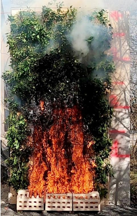
**Abb. 6:** Fotodokumentation des Brandversuchs Test 3 mit Holz- und Grünfassade zur 3. Prüfminute.
