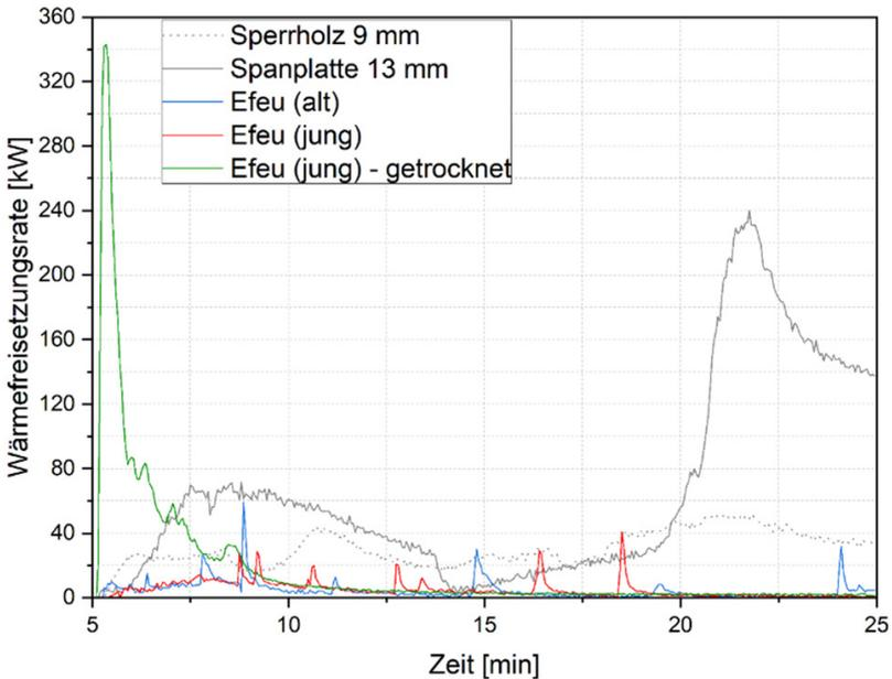
**Abb. 5:** Wärmefreisetzungsrate eines 42 Tage getrockneten, eines vitalen jungen und eines vitalen alten Efeus im Vergleich zu einer 9 mm Span- und einer 13 mm Sperrholzplatte.
