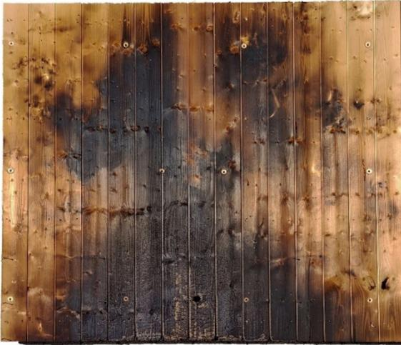
**Abb. 7:** Fotodokumentation der Holzschalung oberhalb der Brandsperre nach Beendigung des Versuches und der Beobachtungszeit für Test 3
