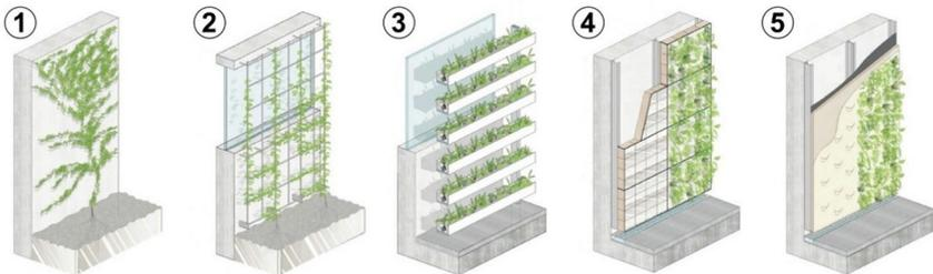
**Abb. 1:** Ausbildungsformen von Fassadenbegrünungen. 1) Direktbewuchs mit Selbstklimmern, bodengebunden, 2) leitbarer Bewuchs an Kletterhilfen, bodengebunden, 3) Pflanzgefäße, horizontale Vegetationsflächen, wandgebunden, 4) modulares System (Living Wall), vertikale Vegetationsflächen, wandgebunden, 5) flächiges System (Living Wall), vertikale Vegetationsflächen, wandgebunden; basierend auf Bildquelle [5]
