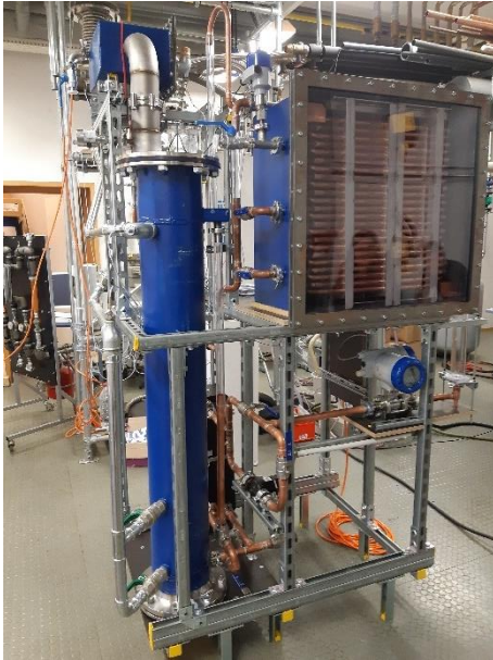
(a) Thermosiphon-Austreiber, Kondensator und Absorber
