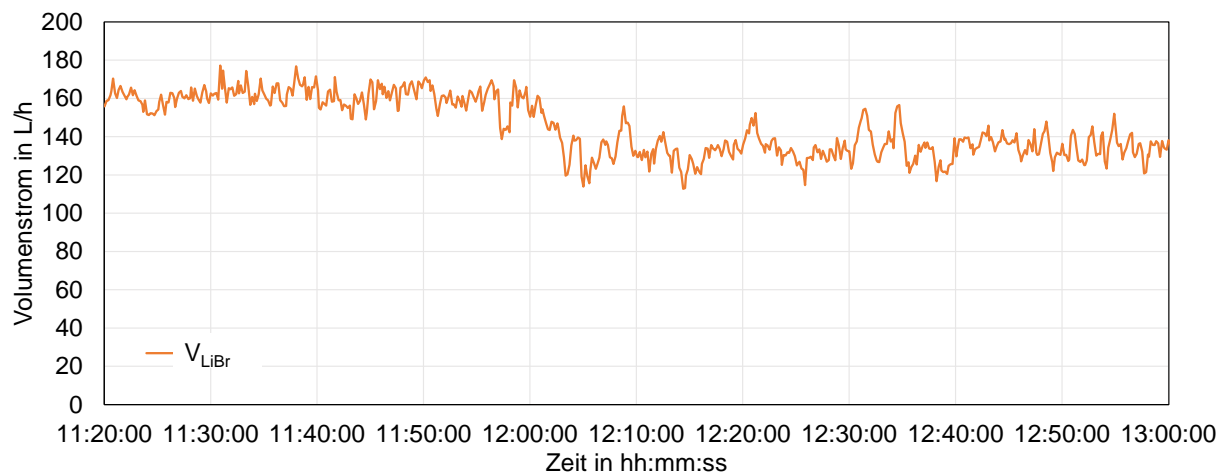
Abbildung 6.20: Volumenstrom der LiBr-Lösung – Erhöhung der Heizwassertemperatur von 80°C auf 85°C
