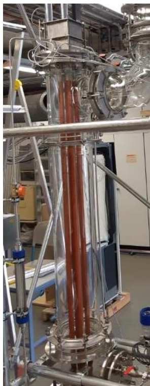
(a) Fallfilmverdampfer mit vier vertikal angeordneten, strukturierten Kupferrohren (b) Übergang von Verdampfer zu Kondensator
