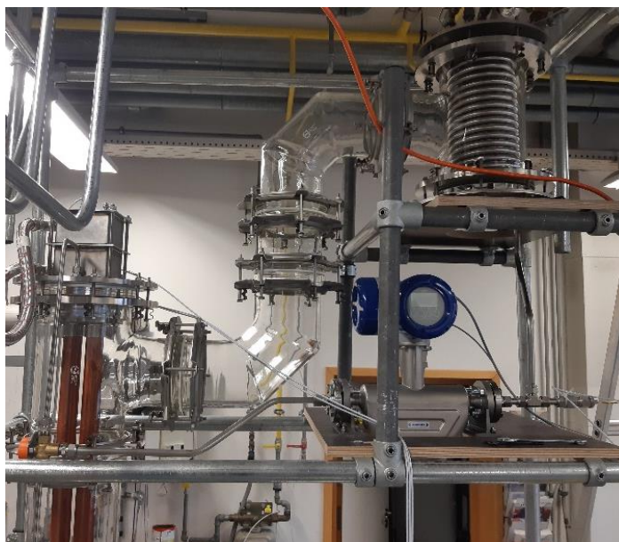
(a) Fallfilmverdampfer mit vier vertikal angeordneten, strukturierten Kupferrohren (b) Übergang von Verdampfer zu Kondensator
