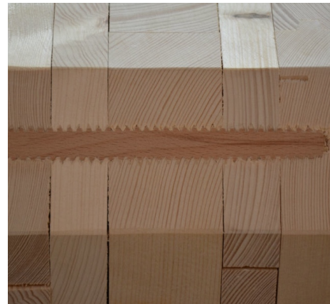
Abb. 2-7: Schnitt durch ein NUR-HOLZ Vollholzelement, aus [36]
