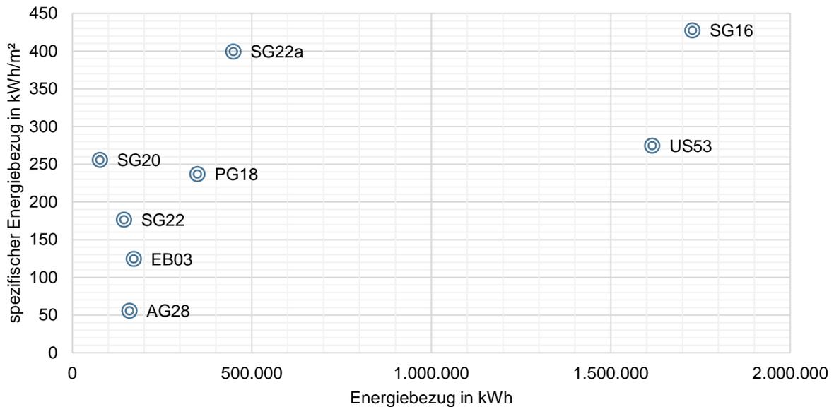
Abb. 29: Energiebezug und spezifischer Energiebezug der Gebäude des TUMCS
