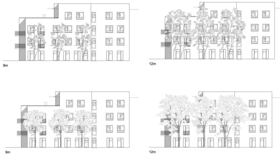
Abbildung 46: Zwei Entwicklungsstadien (nach 5 Jahren (9m) und nach 10 Jahren (12m)) mit gleichen Baumarten: Robinie (oben) und Roteiche (unten) an der Ostfassade (fatkoehl)
