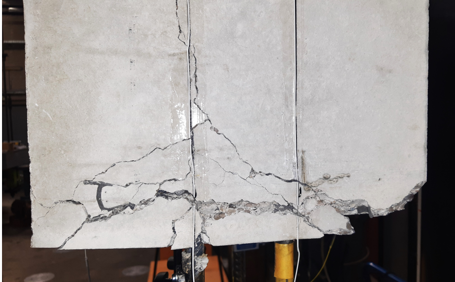
Abbildung B.150: Bruchbild nach Verankerungsversagen von Versuch VDK-8 (Stab 2)
