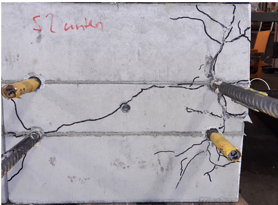
Abbildung B.132: Bruchbild nach Verankerungsversagen von Versuch VDK-4 (Unterseite)
