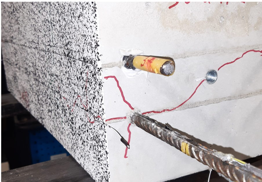
Abbildung B.170: Bruchbild nach Verankerungsversagen von Versuch VDK-12 (Unterseite)
