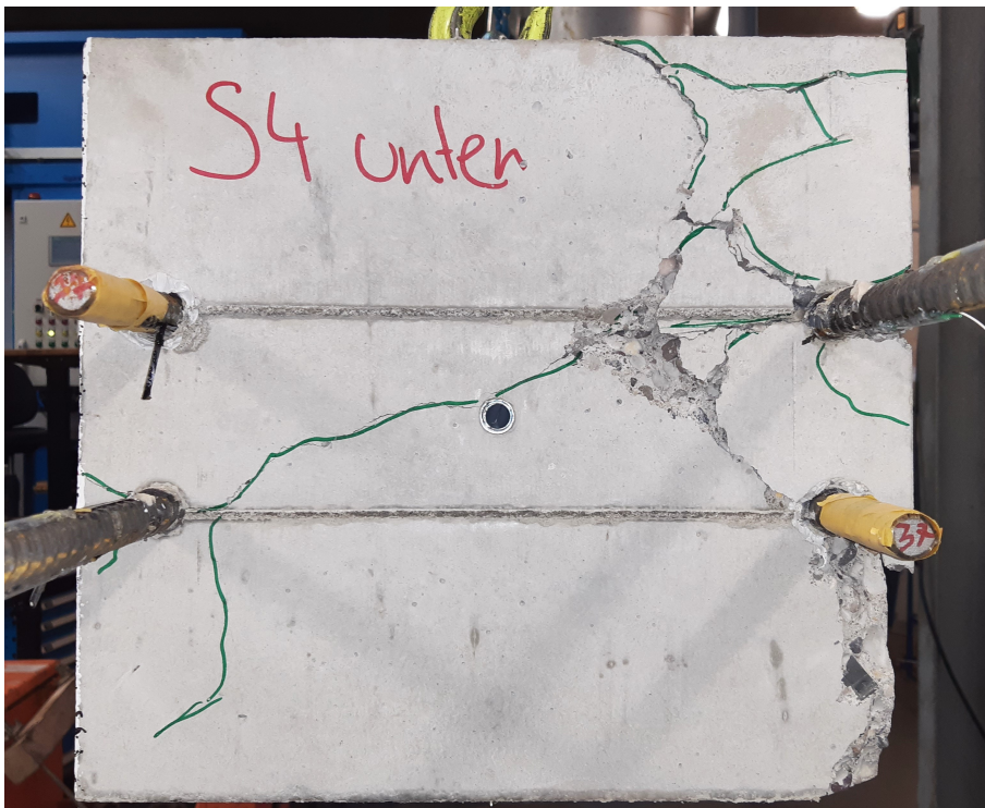
Abbildung B.151: Bruchbild nach Verankerungsversagen von Versuch VDK-8 (Unterseite)
