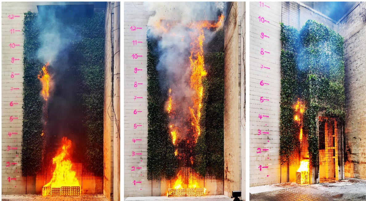
Abbildung 9: Links: Flächiger Versuch mit vitaler Begrünung (V1); Mitte: Flächiger Versuch mit getrockneter (toter) Begrünung (V2); Rechts: Balkonversuch mit Brandeinwirkung in der Ecke mit vitaler Begrünung (V4)
