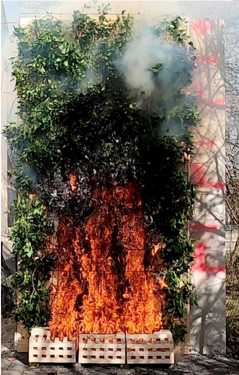
Abbildung 6: Fotodokumentation des Brandversuchs Test 3 mit Holz- und Grünfassade zur 3. Prüfminute
