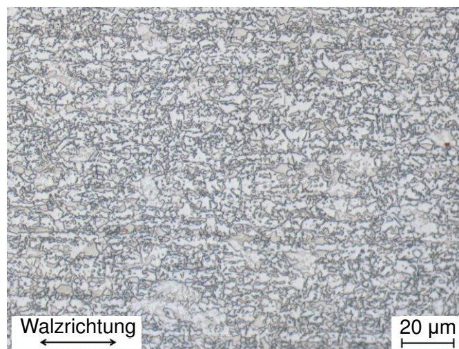
Abbildung 4.2: Gefügeschliffbild des Dualphasenstahls HCT780X+Z
