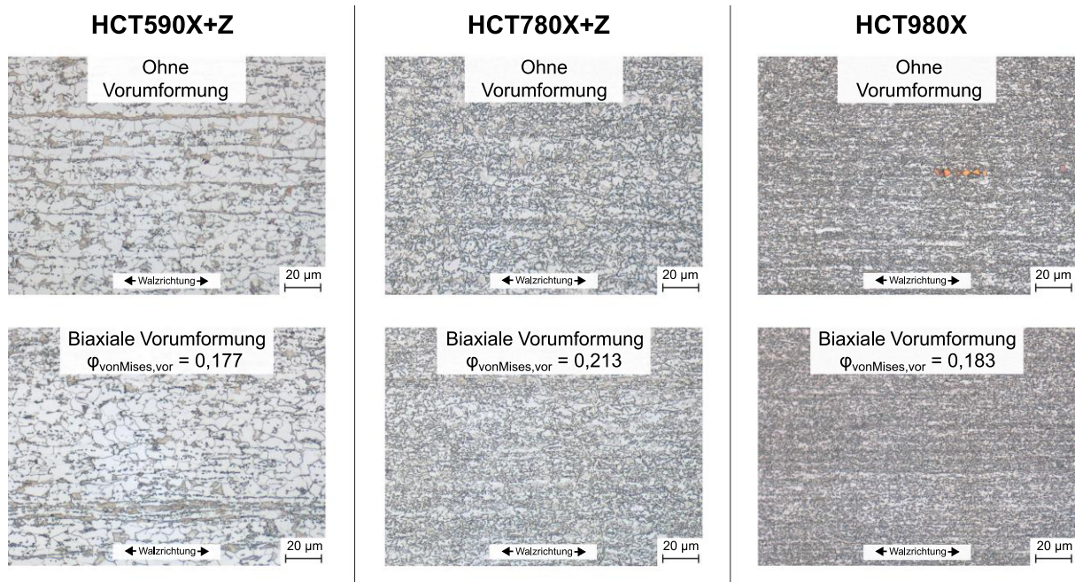
Abbildung 8.20: Einfluss einer Vorumformung auf das Werkstoffgrundgefüge
