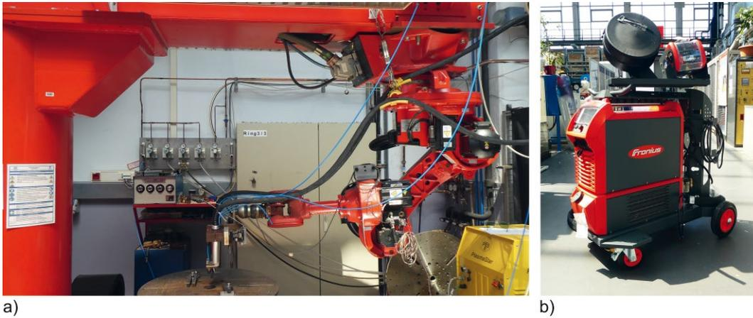
**Bild 8** a) Das Industrierobotersystem Comau SMART NS 16 und b) die Schweißstromquelle 400i der Firma Fronius zum robotergestützten Schweißen mit modifiziertem Kurzlichtbogen Cold Metal Transfer (CMT)
