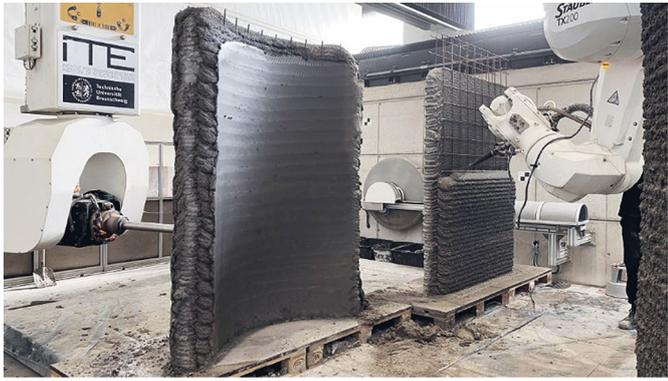
**Bild 2** Digitale Fertigung von bewehrten Betonbauteilen im kombinierten Prozess aus Shotcrete 3D Printing (SC3DP) und präziser Oberflächenbearbeitung durch CNC-Fräsen, entwickelt im AMC A04 Projekt und hier angewendet im DBV-Projekt (PAPER)
