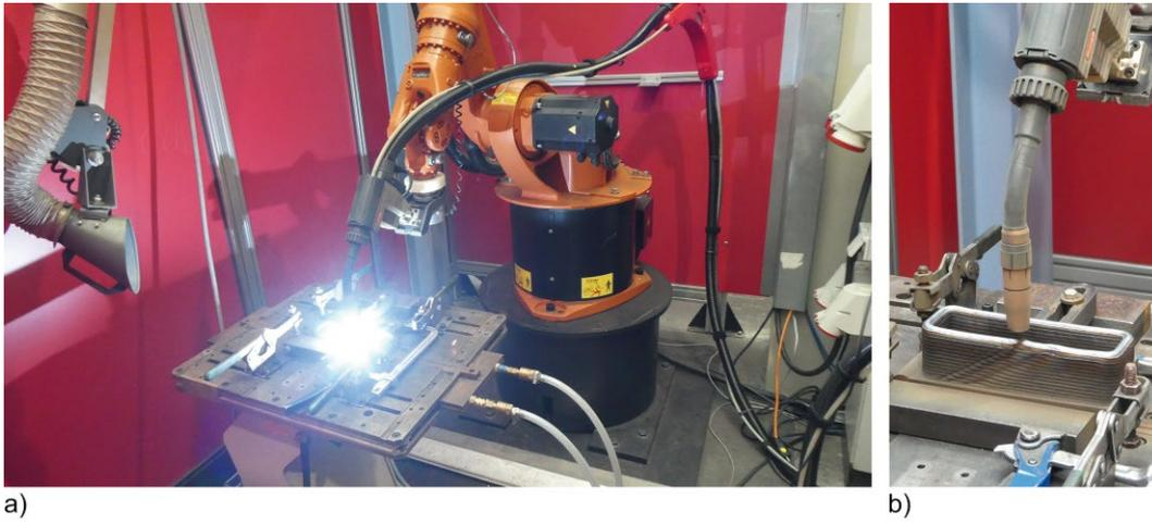
**Bild 7** a) Der Industrieroboter KUKA KR 6 bei der additiven Fertigung von hochfesten Stahlbauteilen, b) charakteristischer schichtweiser Lagenaufbau eines WAAM-Bauteils aus hochfestem Stahl-Zusatzwerkstoff
