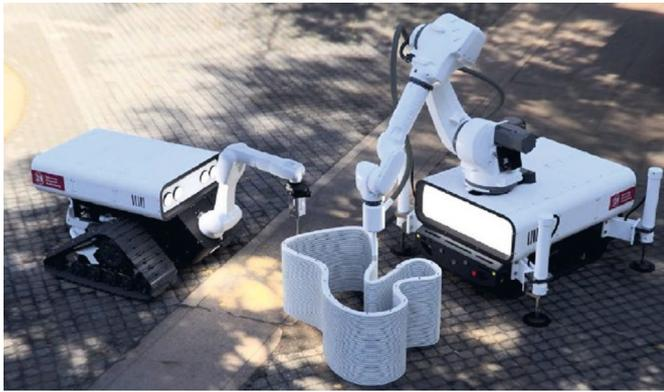
**Bild 18** RoboCoop<sup>3D</sup>: mobile Robotereinheiten für die kooperative digitale Fertigung im Bauwesen (Fa. Baubot)
