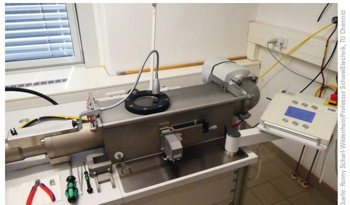
**Bild 9** Das Umform- und Abschreckdilatometer DIL805 A/D der Fa. BÄHR zur reproduzierbaren Untersuchung des Einflusses unterschiedlichster Aufwärm- und Abkühlbedingungen auf die mechanisch-technologischen Eigenschaften von Versuchswerkstoffen
