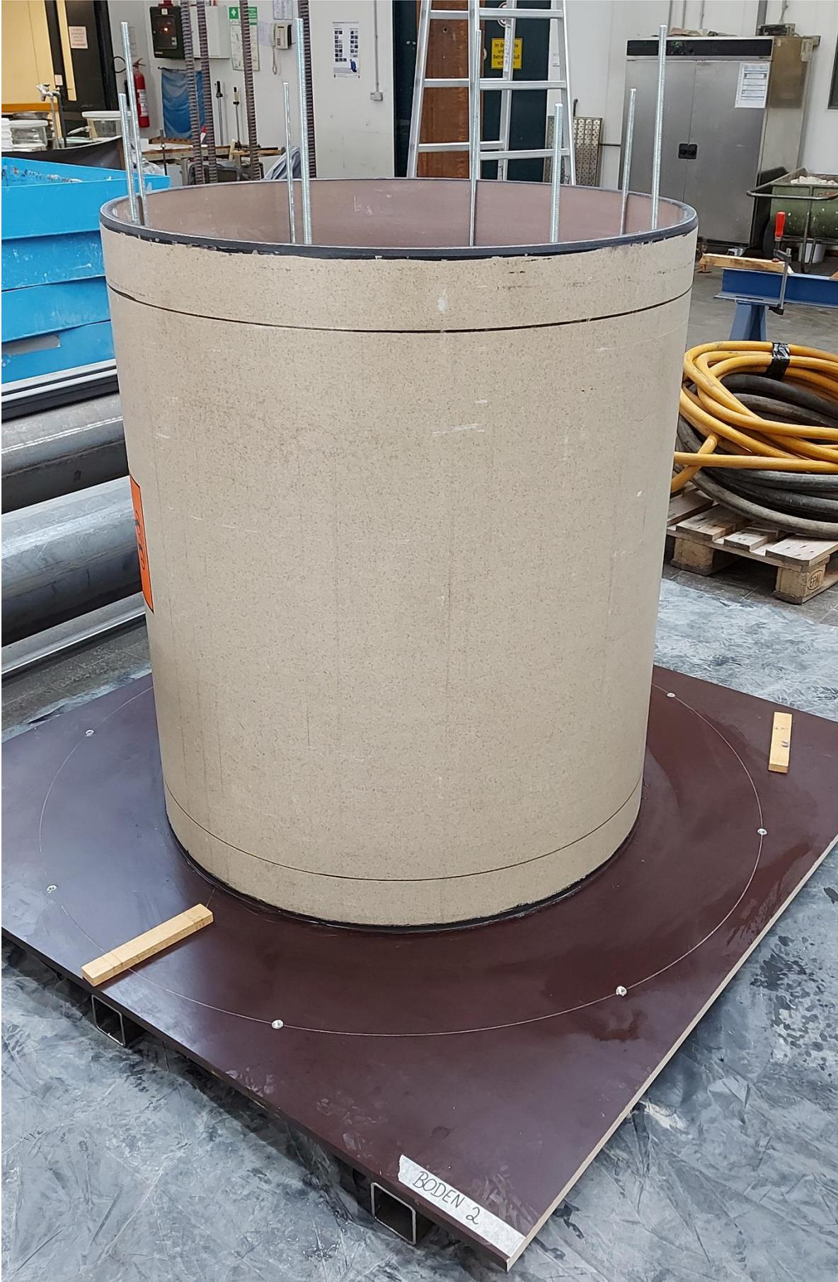
Aufstellen und Abdichten des äußeren Schalungsrings mit eingeschraubten Gewindestangen
