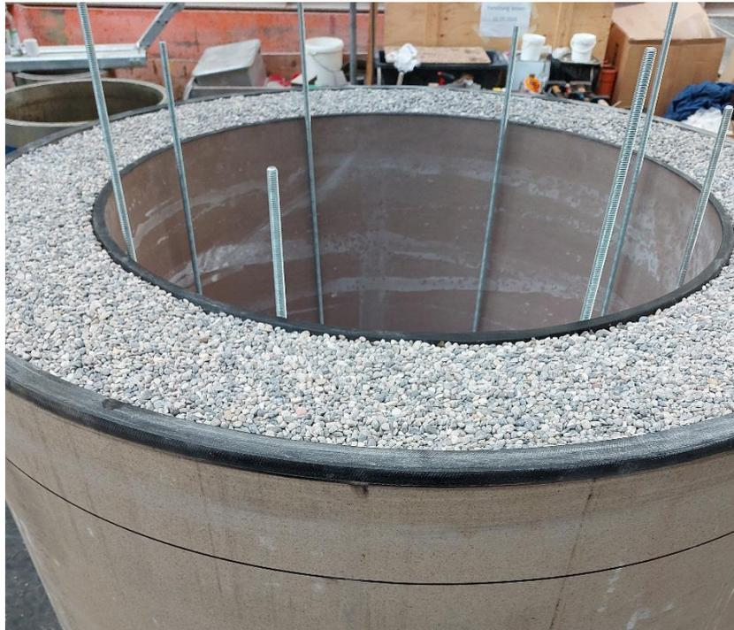
Aufgesetzter Deckel mit zwölf Injektionsöffnungen
