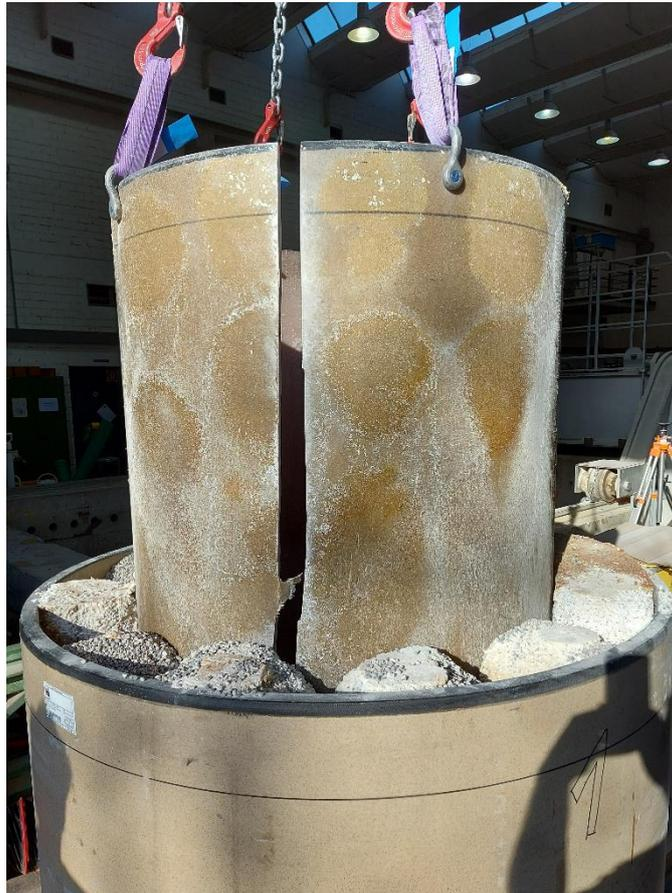
Injektionskörper nach dem Ausschalen ( $V_{inj} = 1,5 \text{ l/Stufe}$ )
