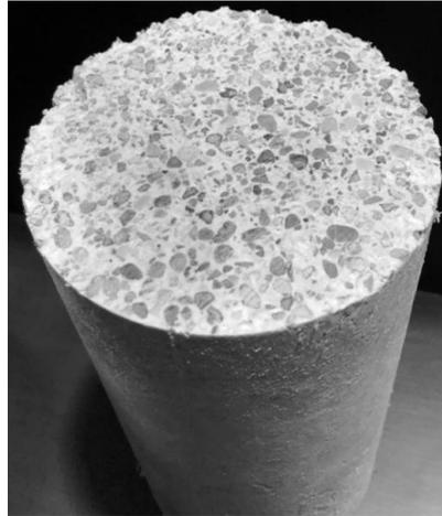
Abb. 3.7: Zugeschnittener Probekörper mit  $H/D \approx 2$
