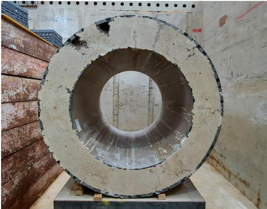
Freigelegter Injektionskörper nach dem Ausschalen ( $V_{inj} = 3,7 \text{ l/Stufe}$ )
