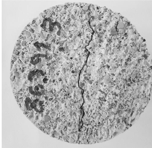
Abb. 3.22: Gerissener Probekörper nach dem Spaltzugversuch ( $fGr$ ,  $I_D = 0,85$ )
