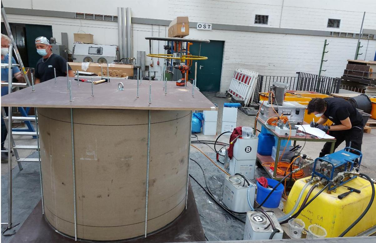
Eingerammte Injektionslanze mit Statikmischer für zweikomponentige Injektionsmaterialien
