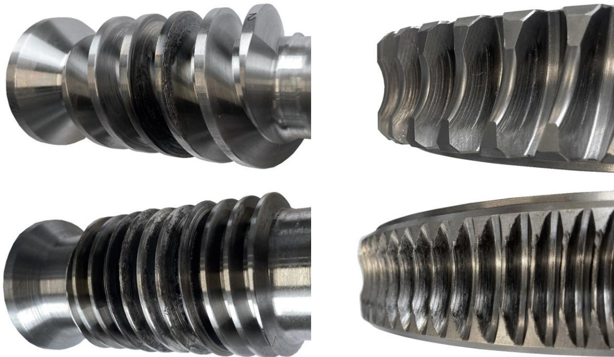
Abbildung 4.14: Aufnahmen von exemplarischen Fresschäden an Schneckenwellen (links) und Schneckenrädern (rechts) der Geometrie Ref (oben) und der Geometrie i80 (unten)
