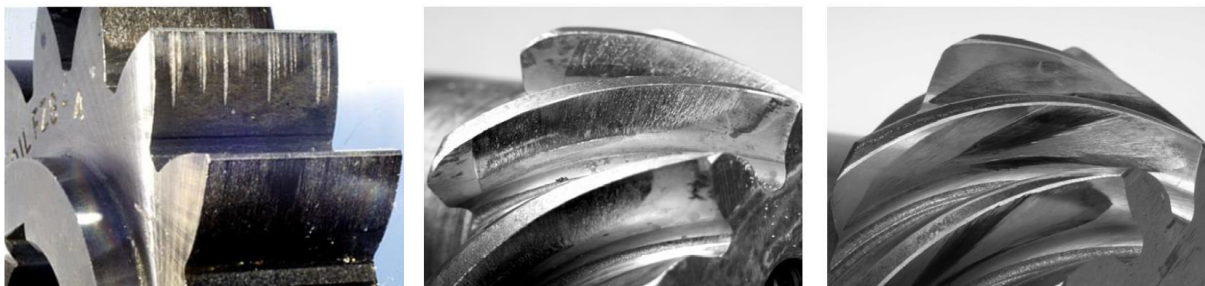
Abbildung 2.9: typische Fresserscheinungen auf (von links nach rechts) Stirnradflanke, Kegelritzelflanke und Hypoidritzelflanke (Abbildungen aus [Sag21] und [Kle12])
