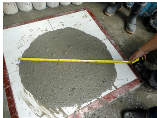
(d) Flow test of SCC
