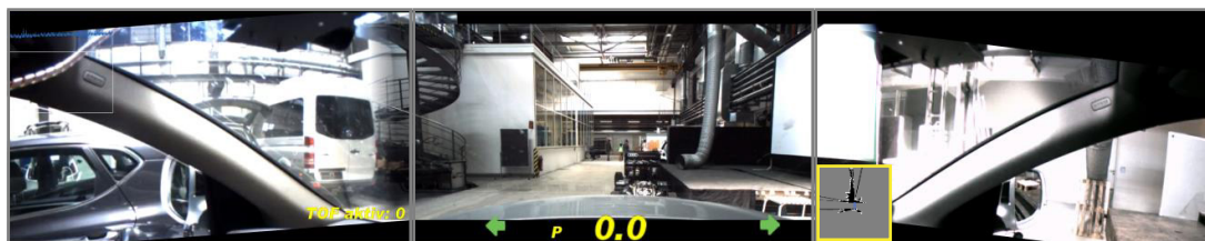
Abbildung 5.2: Bildschirmaufnahme des Monitor-HMI inklusive LiDAR-Daten Visualisierung [171, S. 23]
