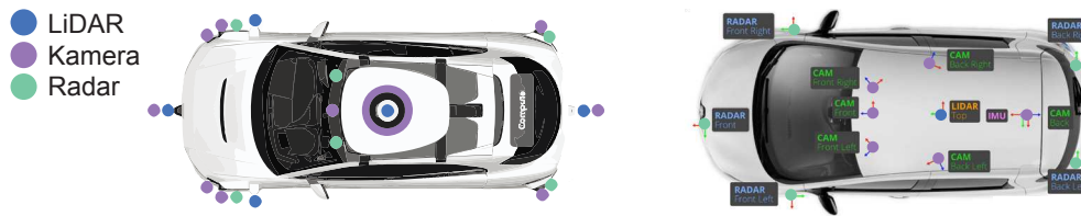
Abbildung 2.8: Sensorsetup verschiedener HAF. Links: Waymo [9]. Rechts: NuTonomy [64, S. 4].
