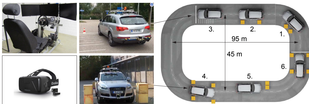
Abbildung 5.4: Von links nach rechts: Fotos der verwendeten HMI [121, S. 14] und des Versuchsfahrzeugs an Station 3 und 4 sowie schematische Darstellung der Teststrecke
