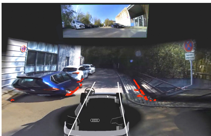
Abbildung 5.16: Visualisierung der LiDAR-Daten als Marker innerhalb des 3-D HMI. Zur Verbesserung der Sichtbarkeit um das Fahrzeug werden Chassisteile ausgeblendet.
