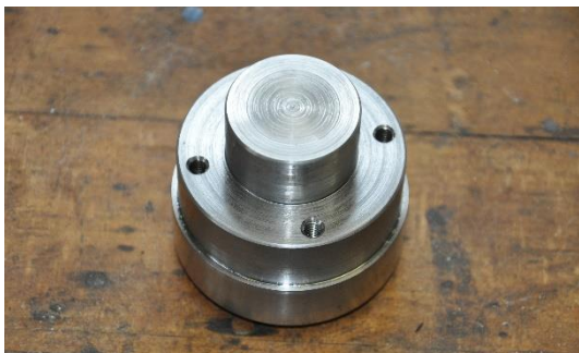
Abbildung 6.13: Aufnahme der Riemenscheiben – generatorseitig
