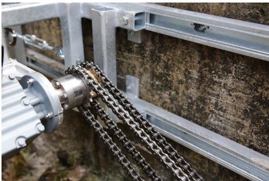
Abbildung 6.9: fertiges Kettengetriebe - Generatorseite
