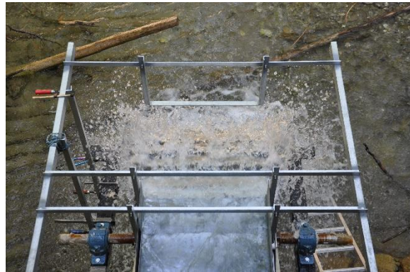
Abbildung 4.14: Spritzverluste am Wasserrad bei Leerlauf
