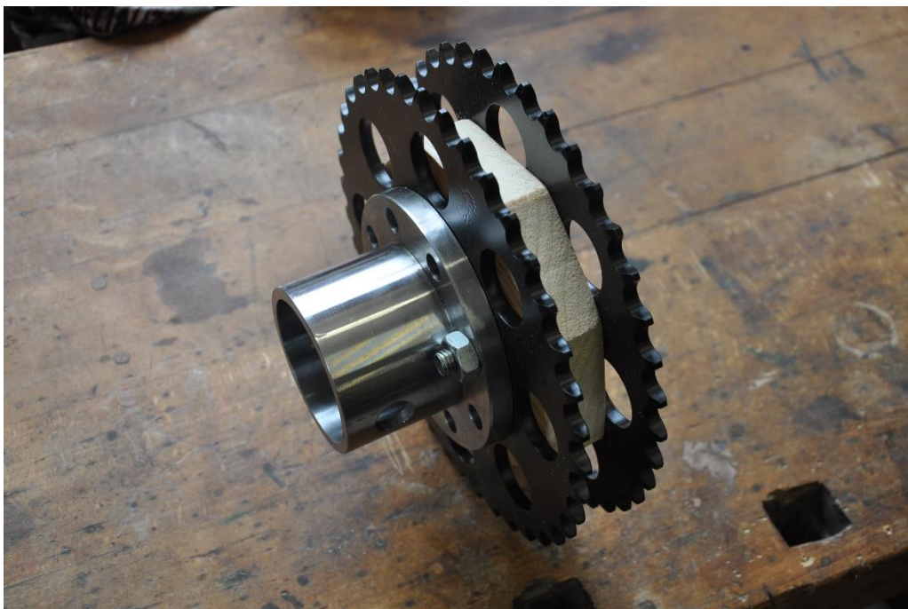
Abbildung 6.6: Generatorflansch mit montierten Kettenrädern
