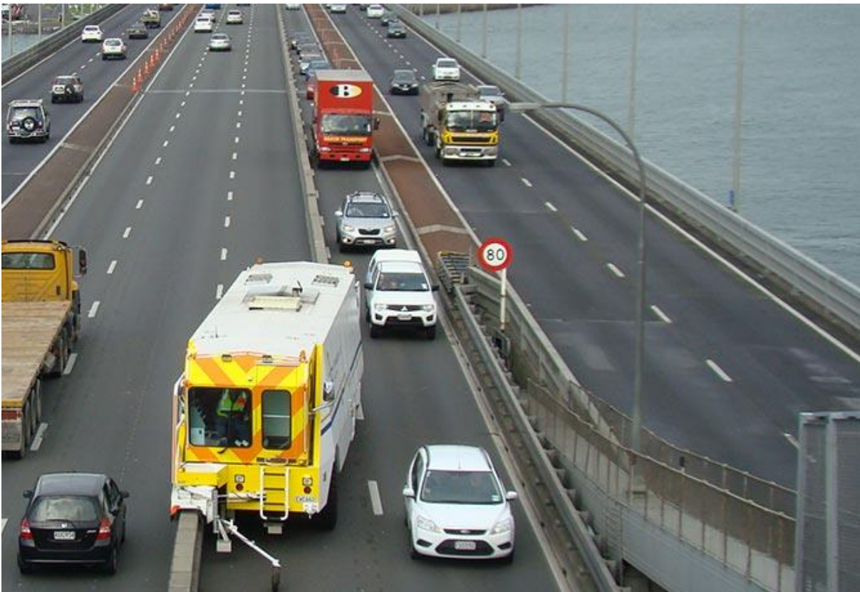
Abbildung 11: Wechselverkehrsstreifen mit verschiebbbarer Mittelleitwand (Lindsay Corporation 2022)
