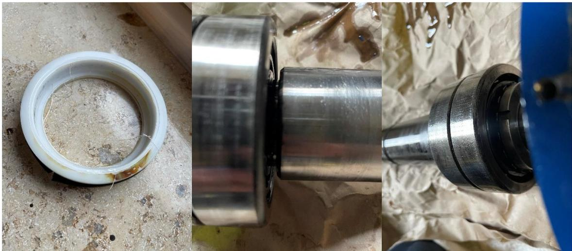
**Abbildung 18:** Beschädigter Laufradprotector (links) und Lager der Pumpenwelle (mittig, rechts)
