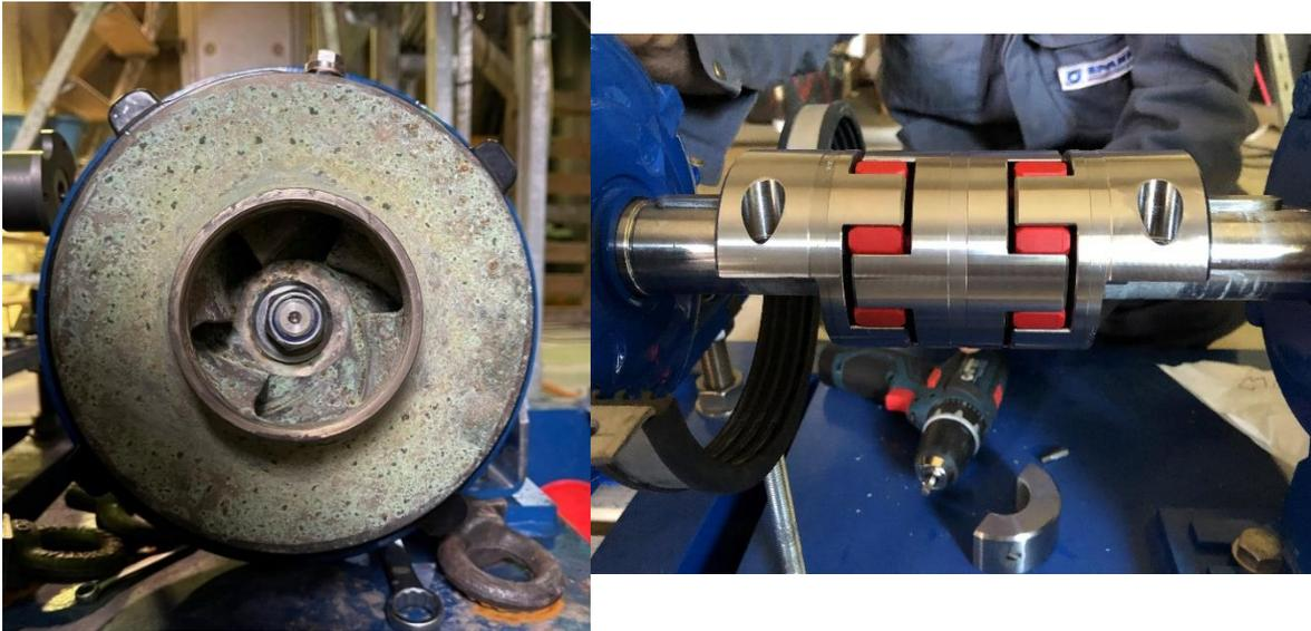
**Abbildung 1:** Lafrad (links) und Kupplung (rechts) einer Kreiselpumpe
