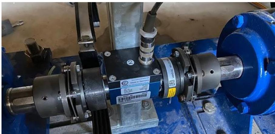
**Abbildung 15:** Drehmomentmesswelle vom Typ DR2412 zur Messung der Drehzahl und des Drehmoments an der Pumpenwelle
