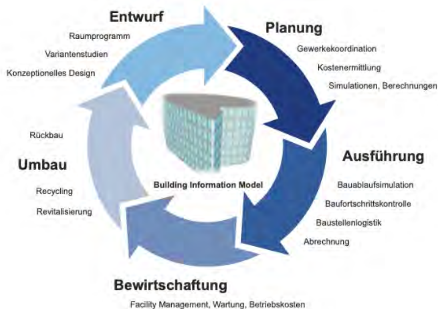
Abbildung 2.2: BIM im Lebenszyklus eines Bauwerks (BORRMANN et al., 2021, S.5)
