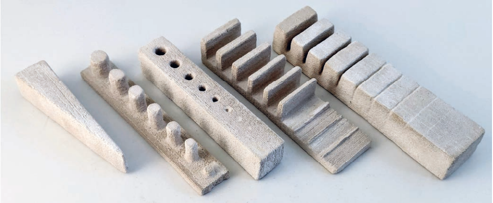
Bild 21: Verschiedene durch selektive Zementaktivierung hergestellte Testobjekte zur Beurteilung der Formtreue | Fig. 21: Selection of test objects produced by selective cement activation to gauge the achievable accuracy
