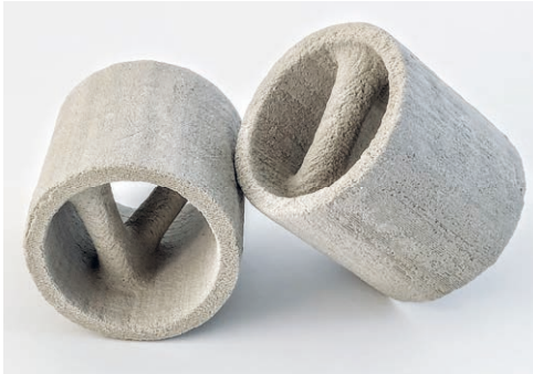
Bild 22: Innen verstrebt Rohrstücke, hergestellt durch selektive Zementaktivierung | Fig. 22: Pipes with internal structures manufactured by selective cement activation
