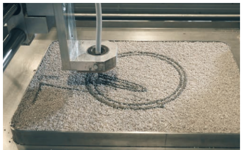
Bild 2: Bauraum des SPI-Druckers während des Drucks mit Einzeldüse und bedruckter Quarzsandschicht | Fig. 2: Build chamber of the SPI printer during printing with nozzle and printed layer
