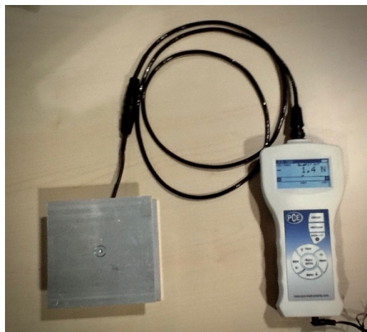
Abb. 12: Versuchsaufbau: Kraftmessplatte und verbundenes Messgerät
