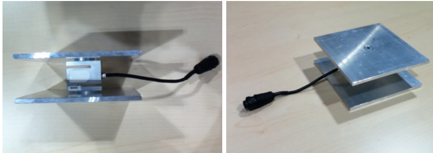
Abb. 11: Kraftmessplatte in montiertem Zustand, links: zwischen den beiden Aluminiumplatten fixierter Kraftwandler
