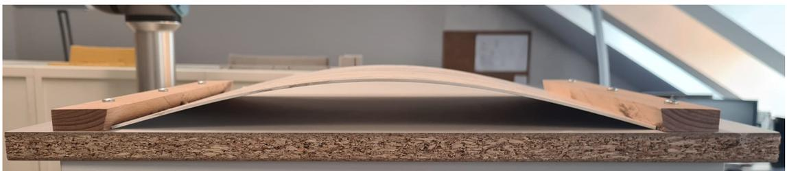
Abbildung 6.6: Erste Stützstruktur für den Nonplanaren Druck
