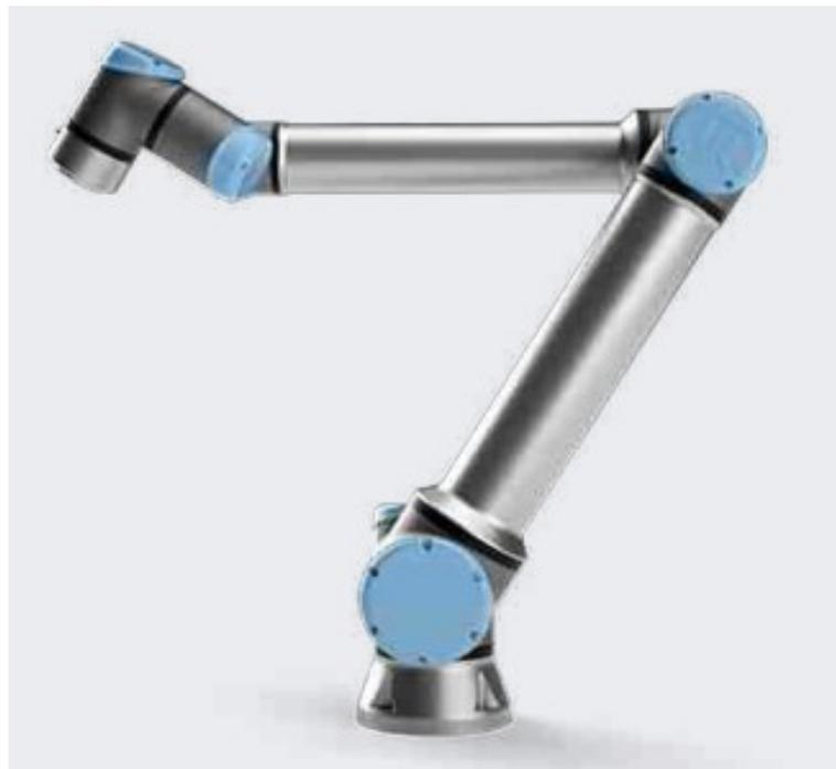
Abbildung 2.26: UR10e Knickgelenkroboter arm der Firma Universal Robots (UNIVERSAL ROBOTS, 2021)
