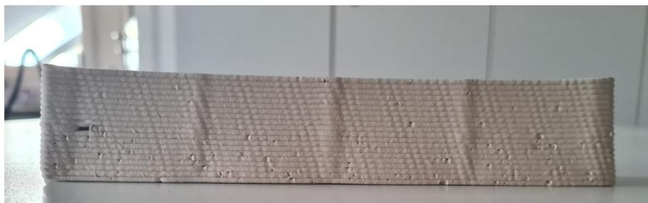
Abbildung 6.9: Testdruck mit angepassten  $\delta$  getrocknet
