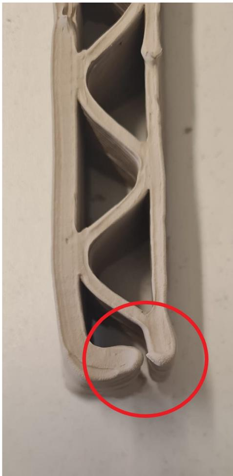
Abbildung 7.1: Auflaffendes Ende der Querseite nach der Trocknung von Oben
