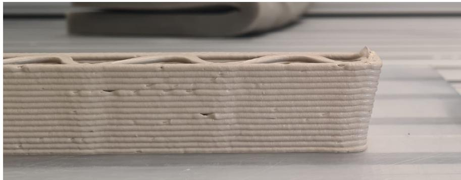
Abbildung 6.15: Seitlicher Überhang zum Ausgleichen der Schräge
