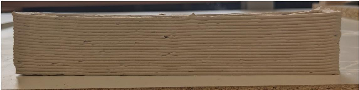
Abbildung 6.17: Testdruck für den Schwindverformungsausgleich trocken
