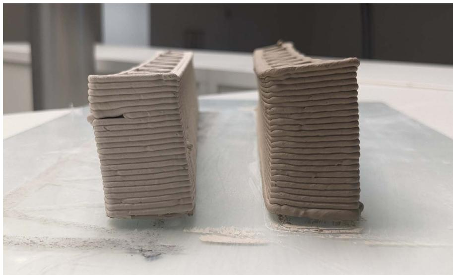
Abbildung 6.20: Die Struktur von [Abb. 6.18](#) links Horizontal gesliced und rechts nicht Horizontal gesliced. Beide Strukturen sind mit 20 Layer gedruckt.
