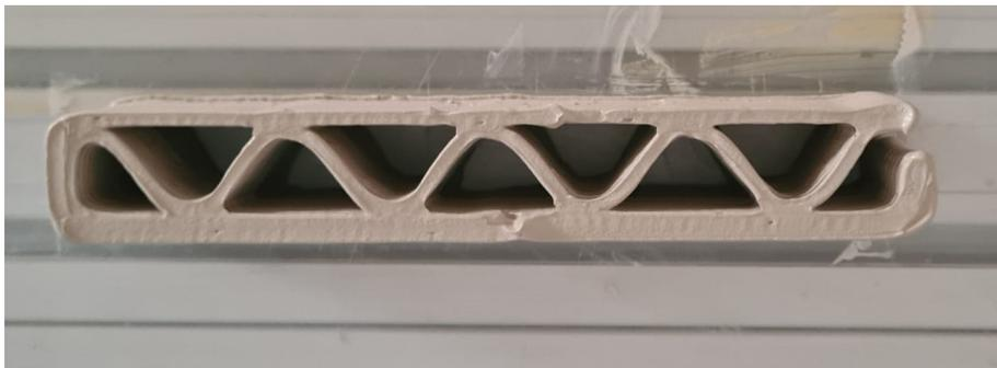
Abbildung 6.3: Testdruck mit ZickZack Fill-in Pattern mit stärkeren Rundungen
