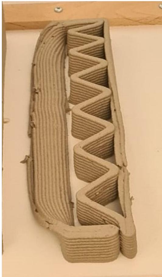
Abbildung 2.18: Die Wand der Testgeometrie ist ausgeknickt, da keine Verbindung zu der Innenstruktur vorhanden war.
