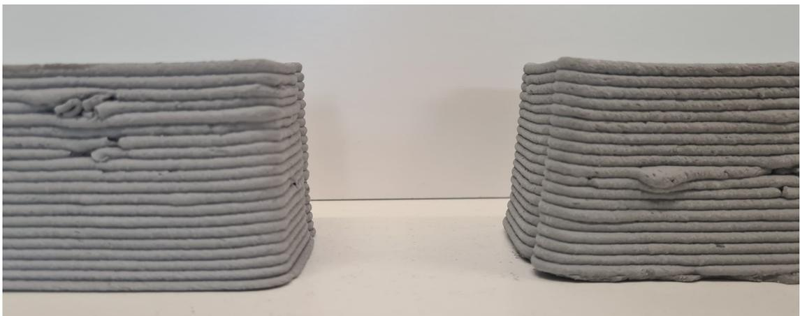
Abbildung 6.13: Links die Teststruktur die auf eine Frischhaltefolie gedruckt wurde. Rechts dazu die gleiche Struktur auf einer Plexiglasscheibe.
