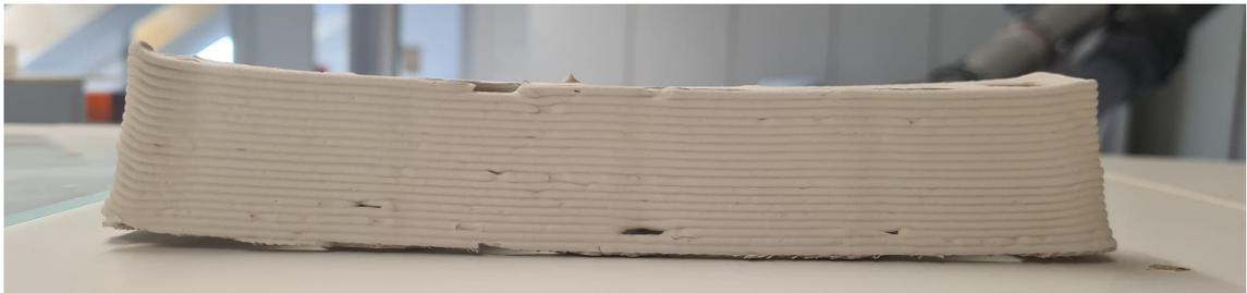
Abbildung 6.11: Die Aufbiegung links sind 2,5mm und rechten 1,5mm bei einer gesamt Länge von 20cm
