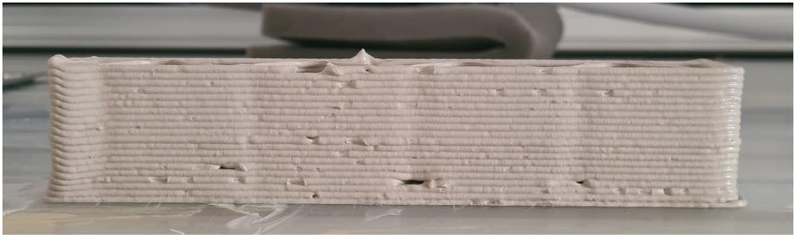
Abbildung 6.16: Testdruck für den Schwindverformungsausgleich frisch
