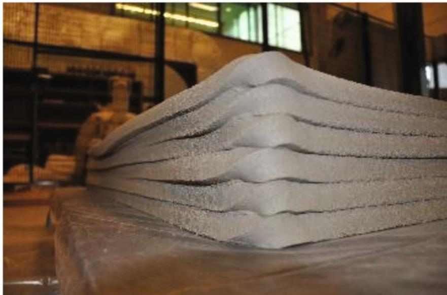
Abbildung 2.9: Durch die fehlende Drehung wird an den Ecken des Drucks das Material gedreht. (SALET et al., 2018)
