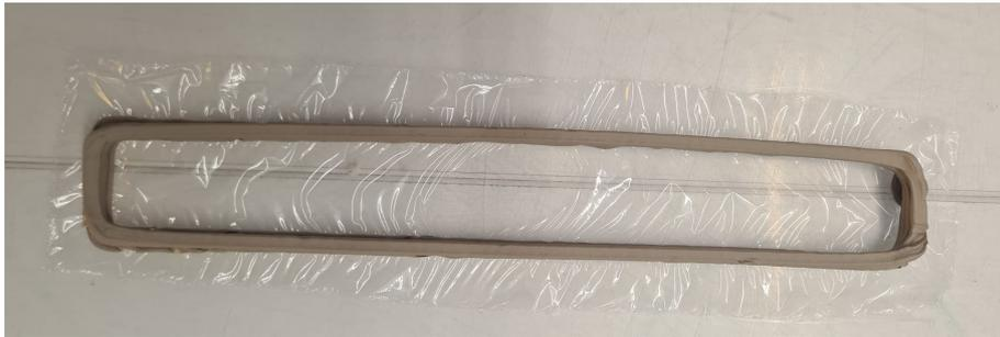
Abbildung 6.5: Getrockneter Testdruck auf einer Plastikfolie
