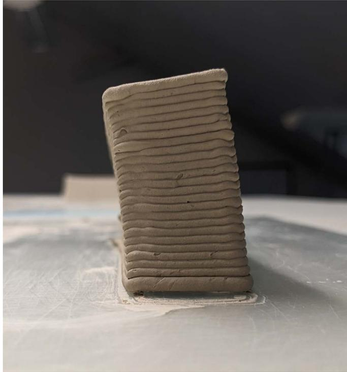
Abbildung 6.21: Die Struktur von [Abb. 6.18](#) nicht horizontal gesliced
