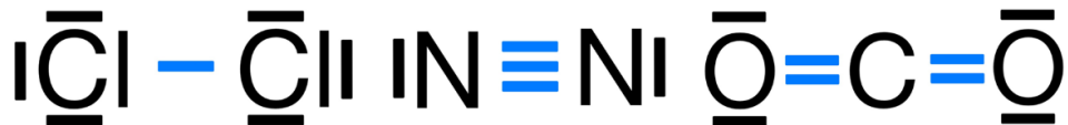
Abbildung 4: Lewis Formeln der Moleküle Cl 2 , N 2 und CO 2 . Blaue Striche stellen bindende, schwarze Striche stellen nicht bindende Elektronenpaare dar.
