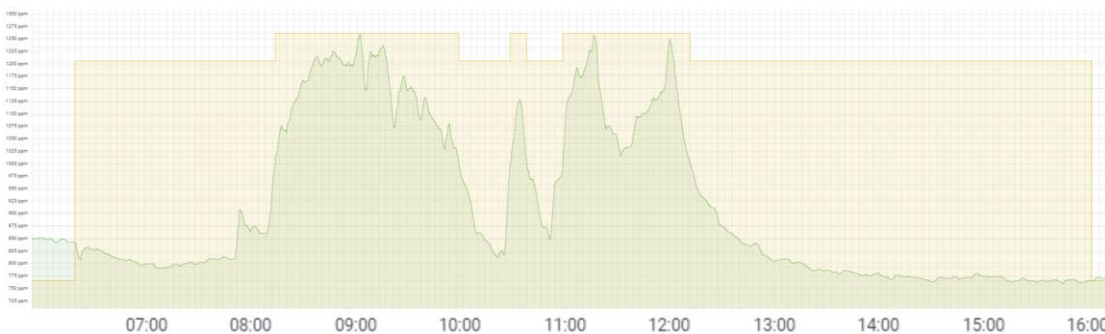
Abbildung 2-19: Verlauf der CO 2 -Konzentration (grün) und Ventilationsstufen des Lüftungsgerätes (gelb)
