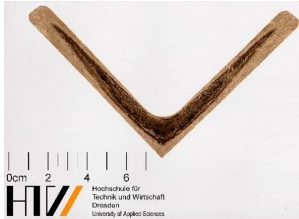
Abbildung 2.1.: Baumannabdruck eines Winkelprofils aus Flusstahl
