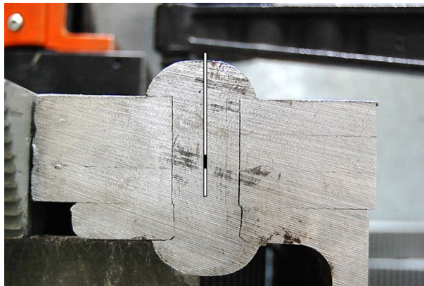
Abbildung 3.2.: Querschnitt Nietverbindung und schematisch dargestellter Dehnungsmessstreifen
