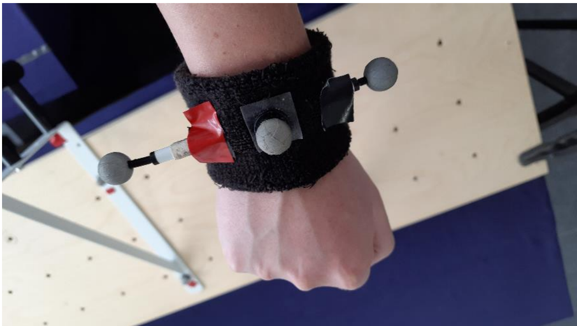
Abbildung 4-6: Schweißband mit verwendeten Markern
