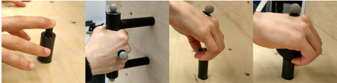
Abbildung 3-5: Grifftypen von links nach rechts: Einfingerkontaktgriff, zylindrischer Griff, Dreifingerkontaktgriff und sphärischer Griff
