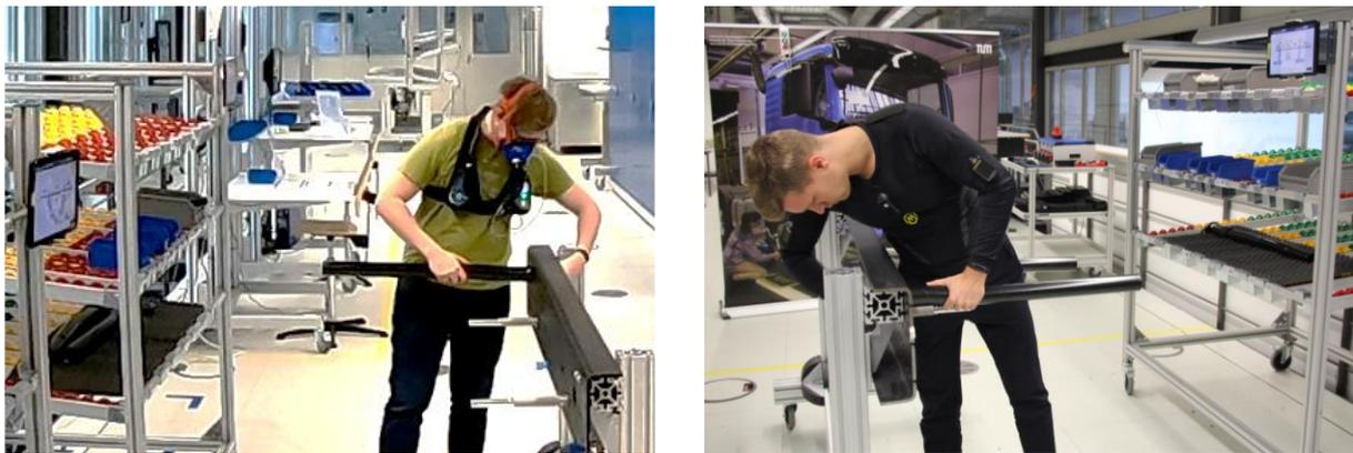
Abbildung 5-22: Vorversuche mit der Spiroergometrie (links) und dem Muskelshirt (rechts) im InnovationLab des *iwB*
