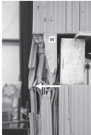
a) Ausknicken der Außen- und Innenlängsstege infolge von Querkzugversagen
