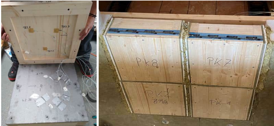
Bild 2 links: Einbau Thermolemente in den Hohlraum von PK3; rechts: Einbau von vier Prüfkörpern in den Ofen als Wandelement
