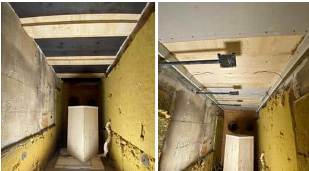
Bild 7 links: Deckensystem unbekleidet; rechts: Deckensystem bekleidet und mit Messstellen
