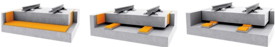
Abbildung 20: Aufbau eines Flächenlagers (links), Streifenlagers (mittig) und Einzellagers (rechts) [46]
