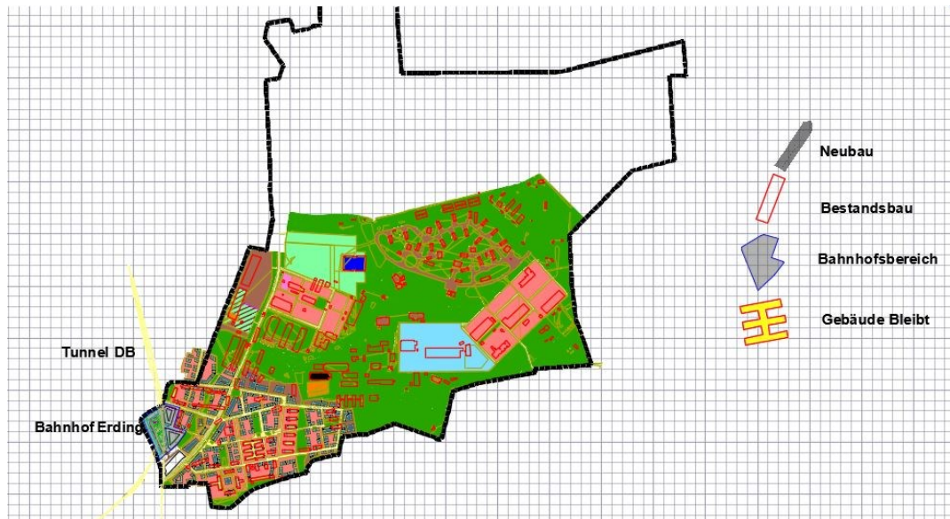
Abbildung 53: Baustellenleitplan FHE AutoCAD
