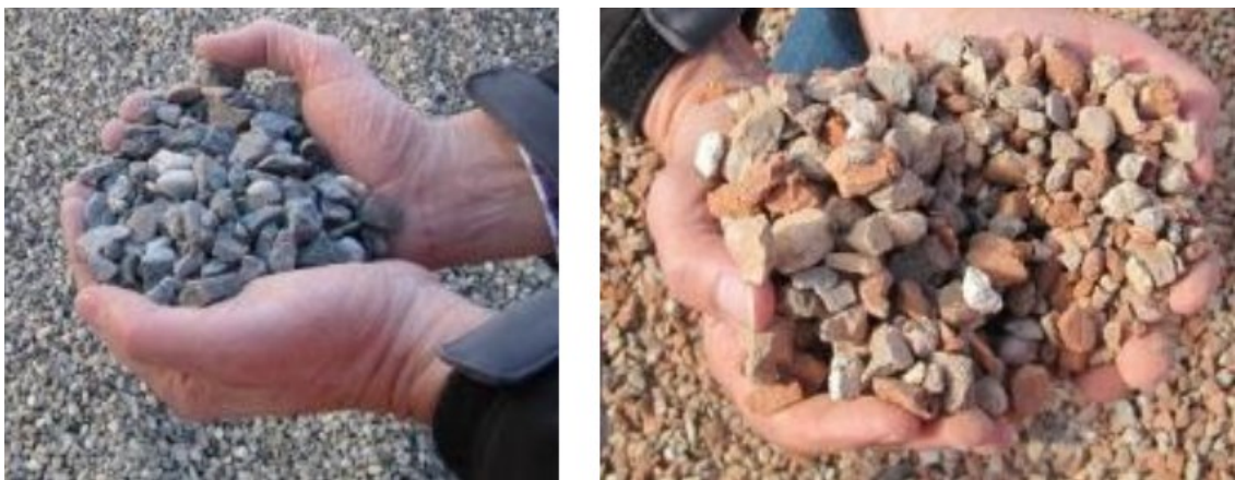
Abbildung 8: Typ 1 Betonsplitt; Typ 2 Bauwerksplitt (Mettke 2017)
