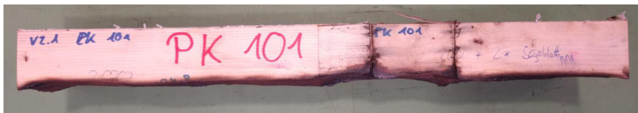
Abbildung 16: Vertiefter Einbrand an Messstellen von Thermoelementen bei Prüfkörper 101 der Versuchsreihe 2.1
