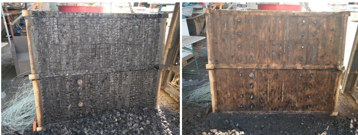
Abbildung 15: Ansicht der brandzugewandten Seite nach dem Brandversuch (links: mit Holzkohleschicht, rechts: gereinigt)
