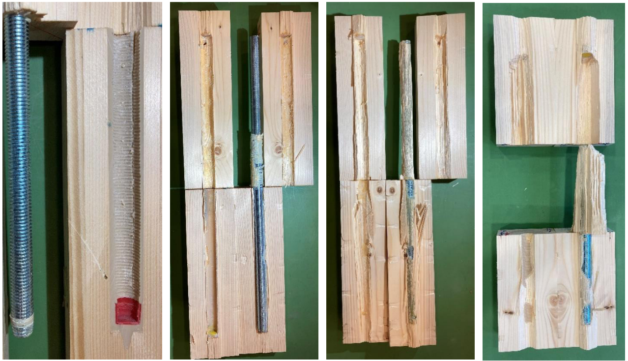
Adhäsionsbruch Klebstoff - Stahl (b)
