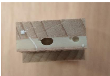
Abbildung 3: Blasenbildung in Prüfkörper mit Fugendicke 3,0 mm
