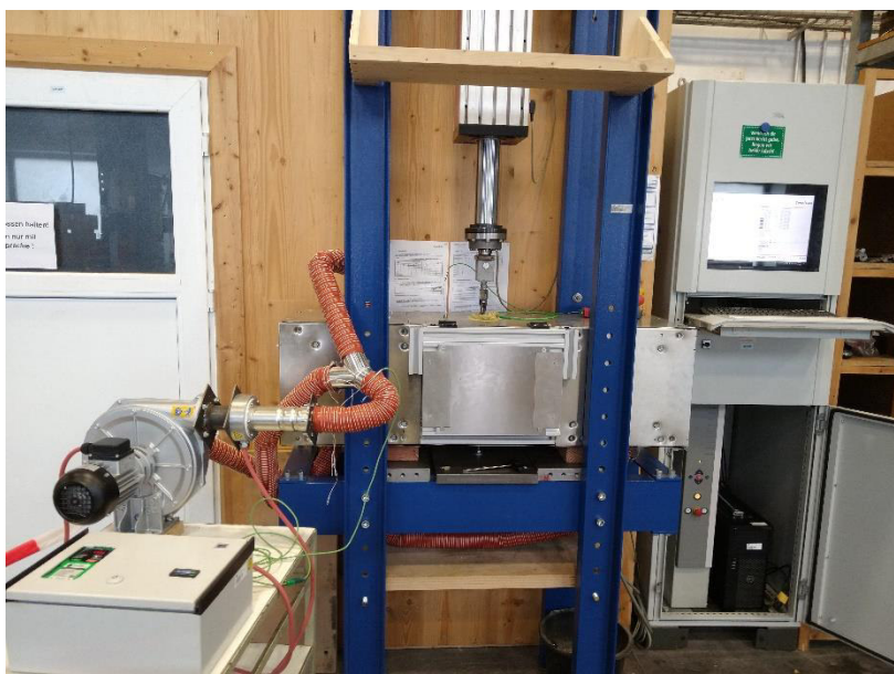
Abbildung 1: Eingebaute Thermobox in Prüfeinrichtung
