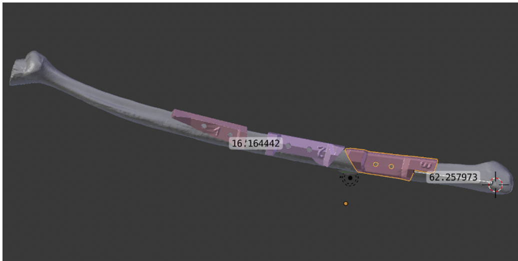
Abbildung 7: Virtuelles Modell der Fibula eines Patienten mit individuell entworfenen Sägeschablonen
