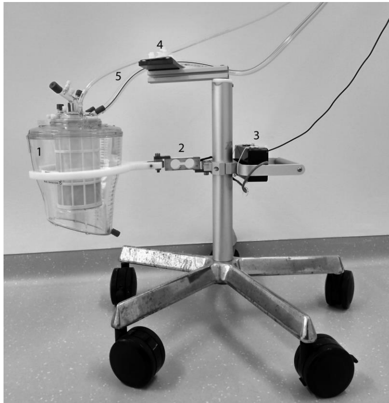
Abbildung 5: Messvorrichtung 1: Kardiotomiereservoir, 2: Wägezelle, 3: Elektronikkomponenten, 4: Befestigung Schlauchklemmen, 5: Schläuche des Reservoirs (Eichhorn et al., 2019)
