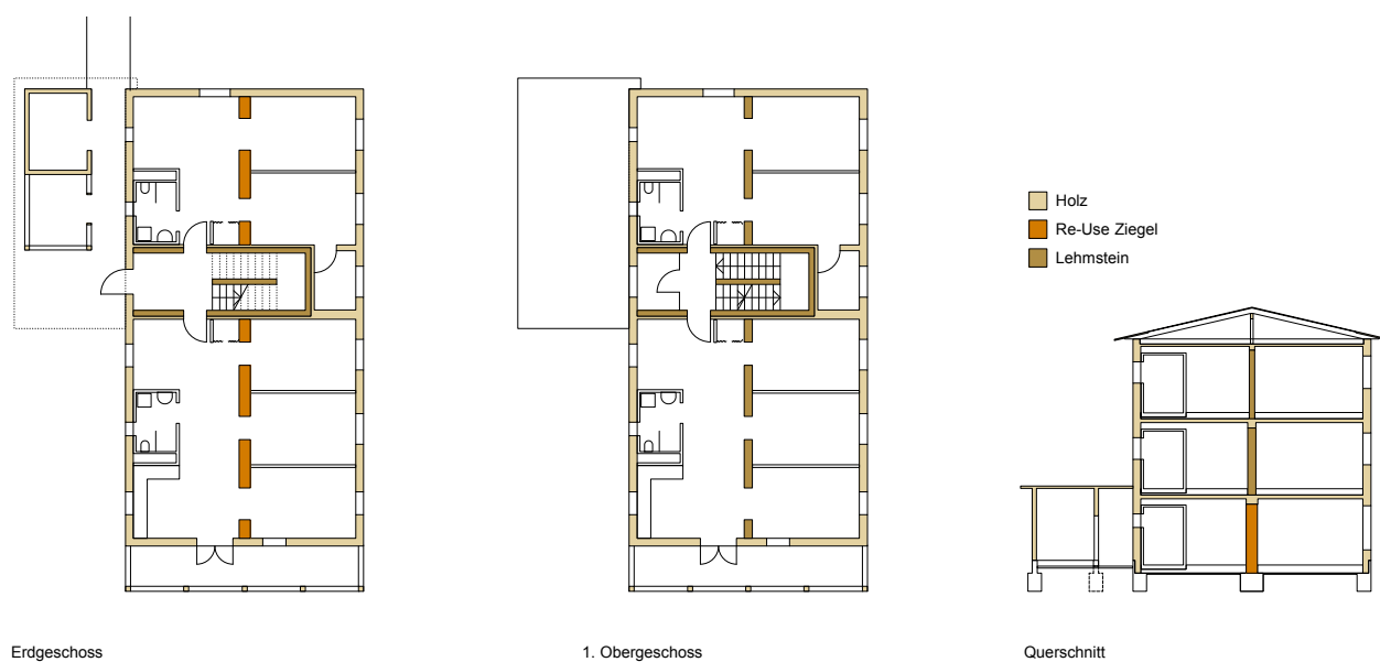
Abbildung 100: Verwendete Materialien von Haus 1, Quelle Florian Nagler Architekten GmbH
