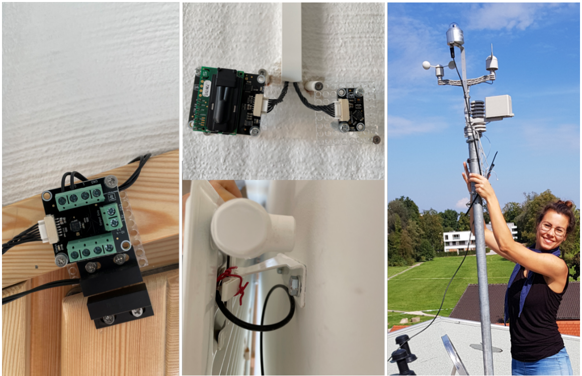
Abbildung 47: Tinkerforge GmbH Sensoren (v.l.n.r.): Fensterkontakt, CO2 (oben, im Bild links), Temperatur und Feuchte (oben, im Bild rechts), PT-Sensor an Heizkörper (unten), Wetterstation mit Pyranometer der Firma Ahlborn
