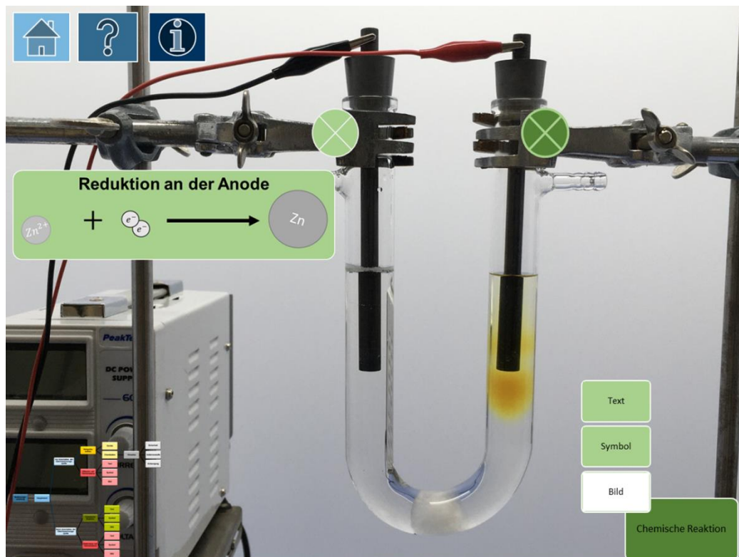
Abbildung 19. Versuchsaufbau in der realen Umgebung mit Ausschnitt des Lernpfads Chemische Reaktion der AR-Lernumgebung (beta-Version); zu sehen ist ein U-Rohr mit zwei darauf befestigten Graphitelektroden, welches zu 2/3 mit einer farblosen Zinkiodidlösung befüllt wurde. Die Elektroden sind mit der Gleichspannungsquelle, die bereits angeschaltet war, verbunden. An der rechten Elektrode zeigt sich eine Gelbfärbung: Das Tablet liefert die bildliche Darstellung der Reduktion (nach Anschalten der Gleichspannungsquelle).
