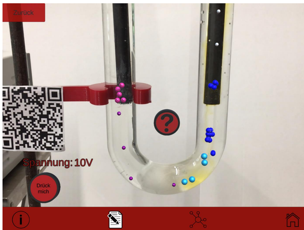
Abbildung 27. Ausschnitt des Lernpfads Elektrolyse auf Teilchenebene (Bild) mit Teilchenbewegungen bei Reaktionsablauf und Button zur Geschwindigkeitsregulation.
