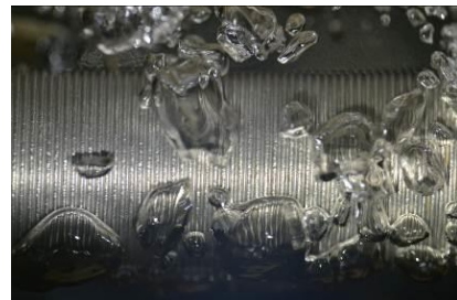
Abbildung 15: Fotografien zur Blasenbildung am Glattrohr (links) und Rippenrohr (rechts) für 1-Pentanol für p^* = 0,01 mit entsprechender Belagbildung
