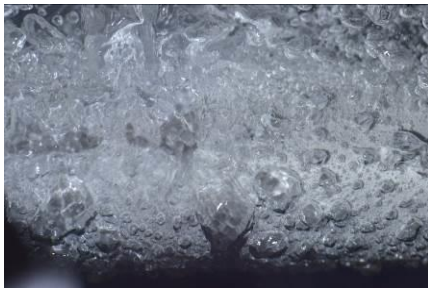
Abbildung 11: Fotografien vom beginnenden bis zum intensiven Blasensieden für das Glattrohr (links) und das Rippenrohr (rechts) für n-Pentan für p^* = 0,1
