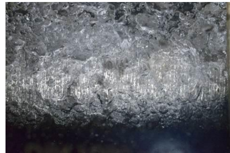
Abbildung 11: Fotografien vom beginnenden bis zum intensiven Blasensieden für das Glattrohr (links) und das Rippenrohr (rechts) für n-Pentan für p^* = 0,1
