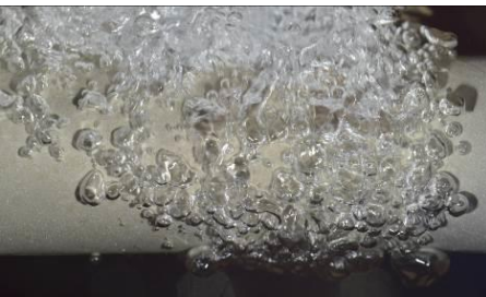
Abbildung 15: Fotografien zur Blasenbildung am Glattrohr (links) und Rippenrohr (rechts) für 1-Pentanol für p^* = 0,01 mit entsprechender Belagbildung
