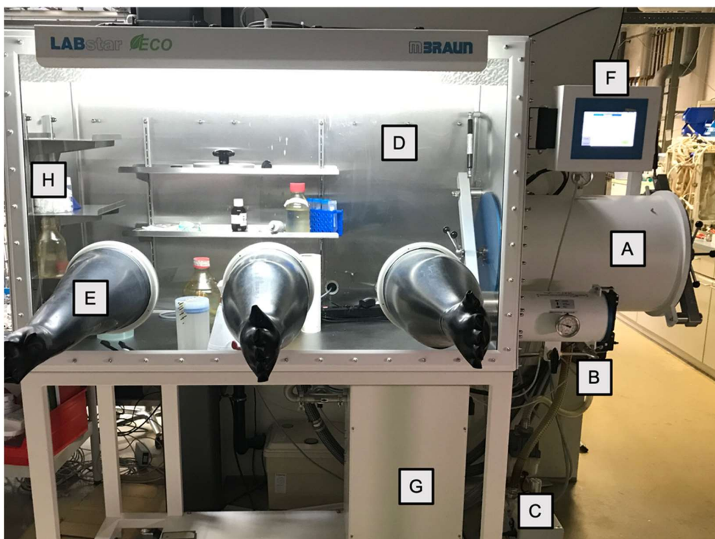
Abbildung 4-1 Anaerobwerkbank MB-Labstar ECO (M. Braun Inertgassysteme GmbH) zur Gewährleistung anaerober Arbeitsbedingungen. (A) Große Schleuse; (B) Kleine Schleuse; (C) Drehschiebervakuumpumpe; (D) gasdichter Raum unter kontrollierter Atmosphäre; (E) gasdichte Butylgummihandschuhe; (F) Regelungs- und Überwachungseinheit; (G) Kupferkatalysator mit Molsieb; (H) HEPA H13 Staubfilter
